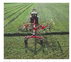
Réglage hydraulique de la trajectoire pour que les dents ne soient pas en position de ratissage en franchissant l'andain.
