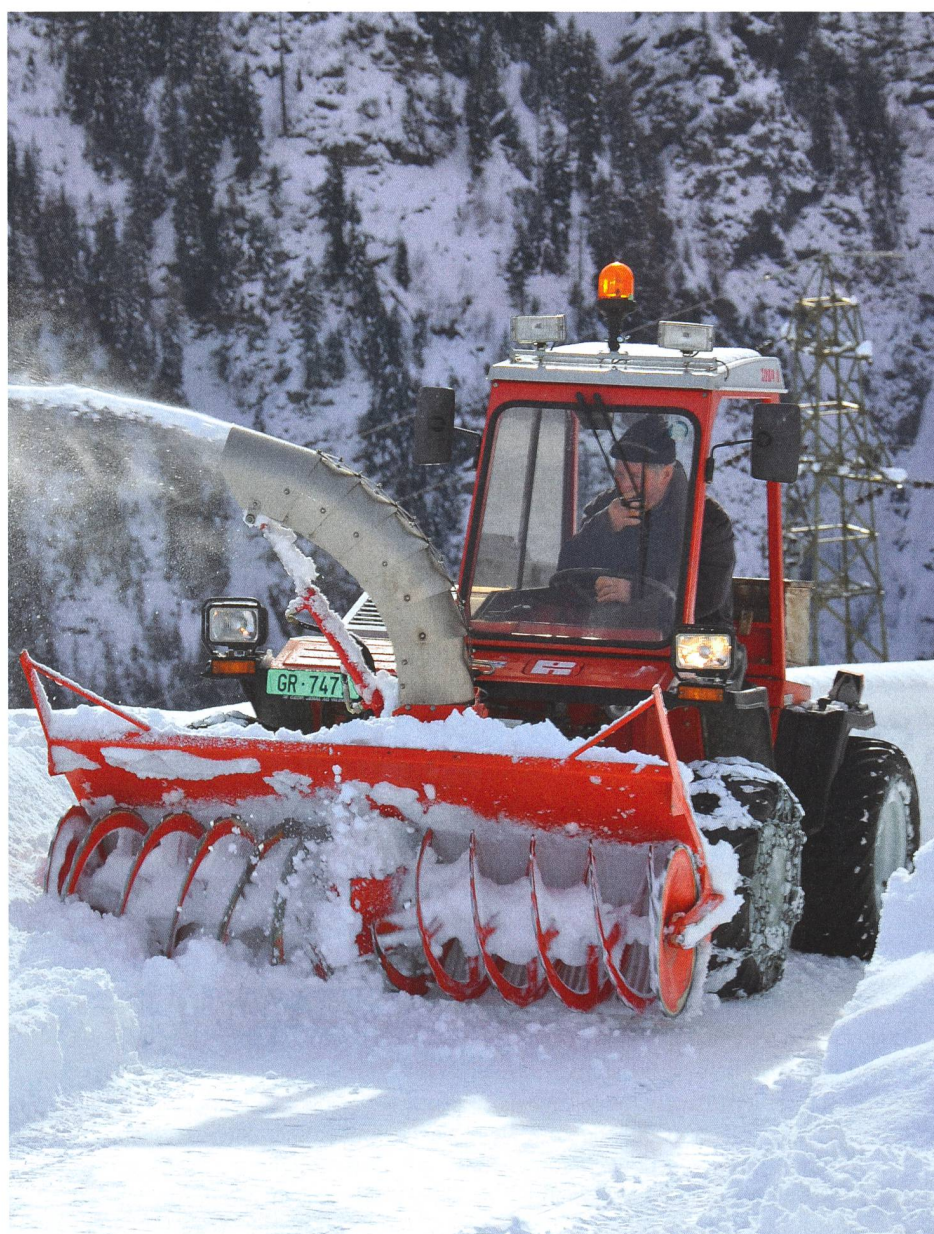
La combinaison de la faucheuses à deux essieux et de la fraise à neige se révèle efficace sur les routes locales et les accès. (Photo: Ruedi Hunger)
