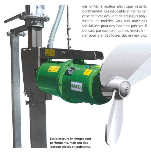
de l'humidité. L'onde de pression générée permet un brassage efficace. Ce type de brasseur est habituellement stationnaire. Les brasseurs à vis disposent d'une plage de pivotement limitée et conviennent donc particulièrement aux fosses rondes. Il existe cependant aussi des versions mobiles. Les brasseurs submersibles exigent une grande puissance d'entraînement.
