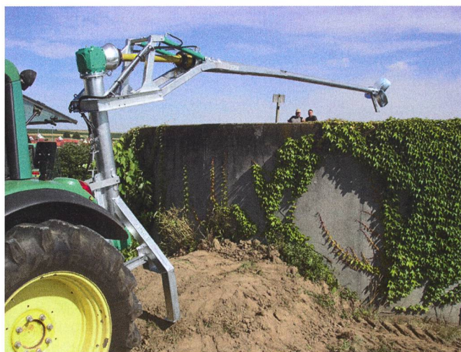
Même les fosses hors sol ne constituent plus un obstacle pour les brasseurs à prise de force. La hauteur se franchit soit par une tour, soit par des éléments articulés.
