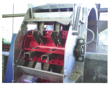
ou à l'arrière de la La tête d'épandage a une action déterminante sur la granulométrie benne, le fond mou- du fumier ou de l'amendement et la distance d'éjection. (Photo: Saco)
