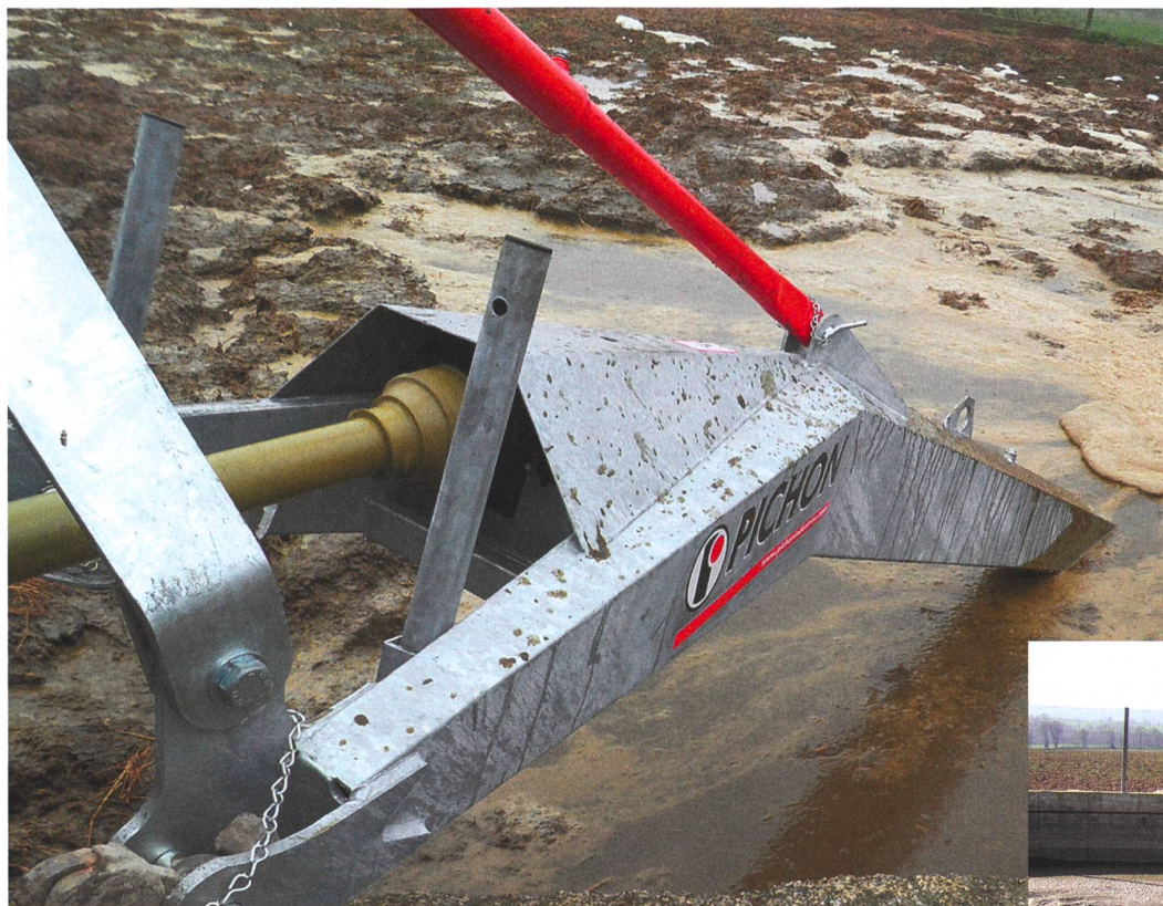
Bien mélangé, à moitié épandu: les brasseurs à prise de force sont performants et peuvent être utilisés de manière souple. (Photos d'usine et de Ruedi Hunger)
