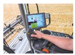
Fendt poursuit sa stratégie avec un seul terminal au moyen du concept d'exploitation Variotronic. Toutes les fonctions, telles les réglages, le guidage par traces et la documentation, passent par le même terminal, qu'il s'agisse des tracteurs des séries 500 à 900, des ensileuses Katana ou des moissonneuses-batteuses.
