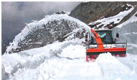
Les importantes hauteurs de neige nécessitent un travail en plusieurs étapes lors de l'ouverture de cols. Ici une fraise-souffleuse au travail.
