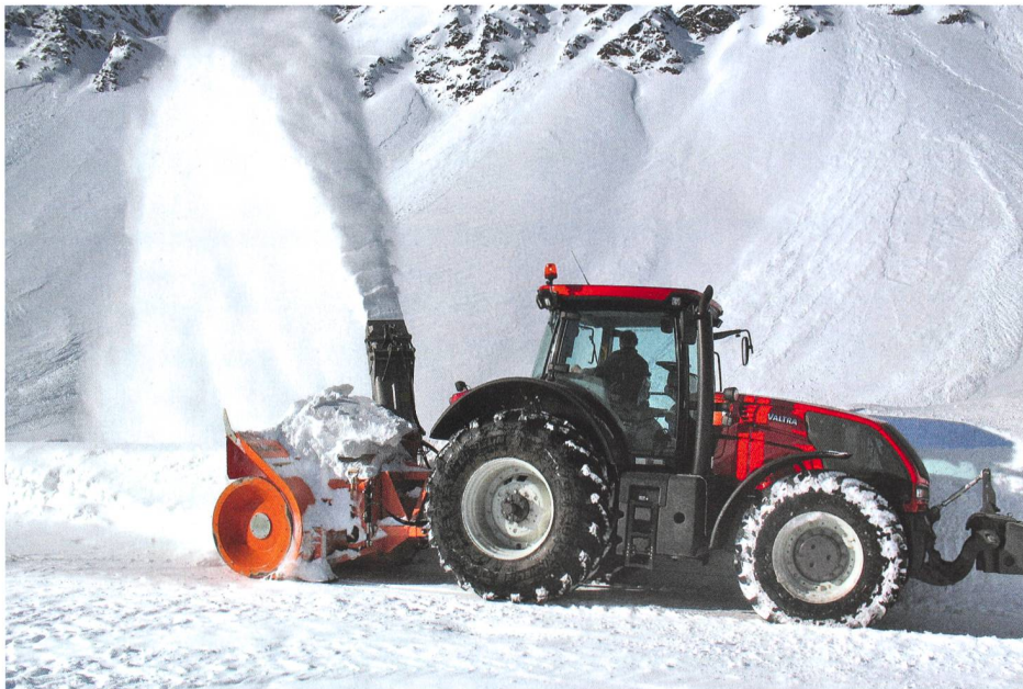
Les tracteurs avec élément arrière s'avèrent adaptés aux travaux de déneigement lourds.
