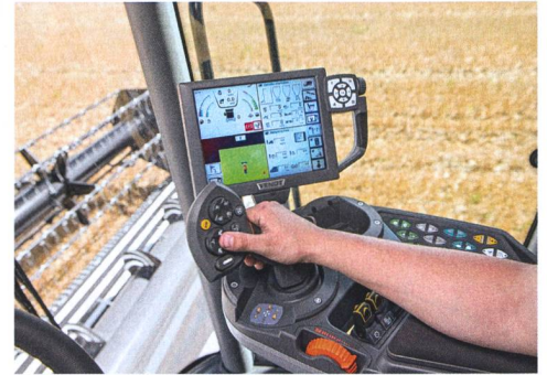
Fendt poursuit sa stratégie avec un seul terminal au moyen du concept d'exploitation Variotronic. Toutes les fonctions, telles les réglages, le guidage par traces et la documentation, passent par le même terminal, qu'il s'agisse des tracteurs des séries 500 à 900, des ensileuses Katana ou des moissonneuses-batteuses.
