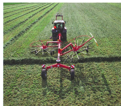
Réglage hydraulique de la trajectoire pour que les dents ne soient pas en position de ratisage en franchissant l'andain.
