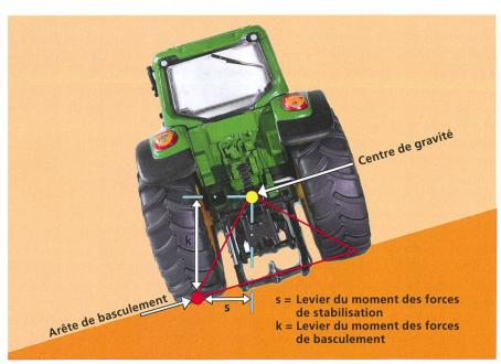
Un centre de gravité bas, éloigné de l'arête de basculement, améliore la stabilité d'un objet. Mais si l'inclinaison augmente, le centre de gravité va s'élever, et le levier exercé par les forces de basculement va s'allonger (longueur k). En même temps, la distance entre le centre de gravité et la verticale de l'arête de basculement se réduit, tout comme l'effet levier des forces de stabilisation qui maintient le tracteur debout (longueur s).
