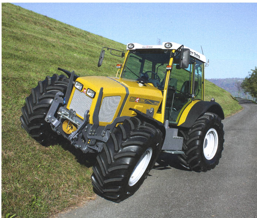
Il y a un marché de niche pour des tracteurs bien adaptés aux pentes. Le relevage frontal est solidaire de l'axe avant, un concept qui a fait ses preuves sur les faucheuses à deux essieux.
