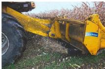
Le ramassage des restes de récolte de maïs prend de plus en plus d'importance. Cette biomasse peut être utilisée comme matière première renouvelable dans des centrales de cogénération ou de biogaz, mais aussi comme litière dans l'élevage. Le **Cornrower** est constitué d'un broyeur sous cueilleur qui réduit les restes de récolte au niveau du cueilleur de maïs équipé de couteaux spécialisés et forme des andains au moyen de déflecteurs en
