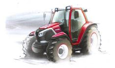
L'essieu arrière du tracteur **Lintrac 90** de Lindner peut être dirigé afin d'améliorer sa manœuvrabilité et son aptitude à travailler avec le chargeur frontal. L'alliance avec des variateurs de vitesse peu répandus dans cette catégorie de puissance permet au tracteur chargeur d'atteindre pratiquement la fonctionnalité d'une chargeuse, pouvant ainsi épargner à l'agriculteur l'investissement supplémentaire dans une machine spéciale.
