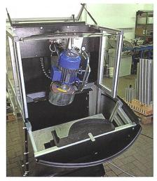
L'AQUA NON STOP COMFORT est le premier appareil d'affûtage de couteaux à eau entièrement automatique pour les couteaux de remorque-chargeuse et de presse. Indépendamment de l'état d'usure
