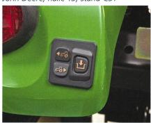
Le tracteur peut être dirigé vers l'avant et l'arrière par une simple pression sur un bouton de l'extérieur de la cabine. Ceci permet non seulement d'atteler les outils plus facilement mais aussi de façon plus sécurisée puisque la montée et la descente du tracteur, causes de grand nombre d'accidents, sont ainsi considérablement réduites. Le système est commandé par le frein à main enclenché, ainsi également utilisable en pente.
