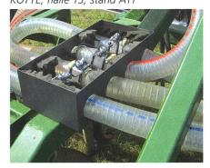
Le suivi et le contrôle du débit dans les tuyaux de répartition représentent indépendamment de l'outil choisi un défi, particulièrement lors de l'apport de lisier dans le sol. Le capteur novateur (**Flow-Check**) surveille de façon sonore le débit de chaque tuyau de répartition. Dès que le flux de lisier est interrompu, le conducteur reçoit un signal acoustique – un
