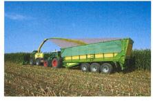
Un **scanner au laser** reconnaît le véhicule roulant derrière la récolteuse-hacheuse et fait pivoter la goulotte. Ainsi, cela évite les pertes de fourrage au démarrage de la récolte. Un chargement automatique en parallèle est possible avec ce système en mode de récolte normal. La tête du laser est bougée de haut
