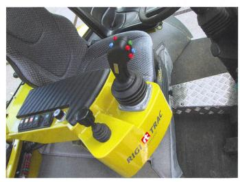
Le joystick et le levier de commande sont identiques à ceux des deux modèles Rigitrac plus grands. L'EHR est cependant inexistant.
