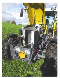
Les radiateurs répartis en triangle sont facilement accessibles pour le nettoyage.
