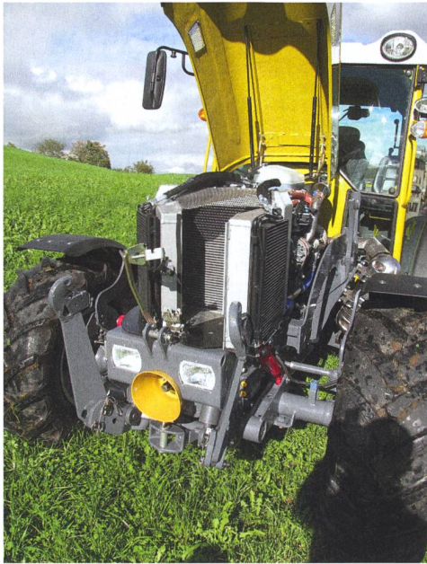
Les radiateurs répartis en triangle sont facilement accessibles pour le nettoyage.
