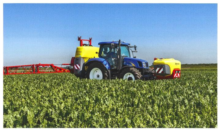
Les deux réservoirs avant et arrière peuvent être utilisés en combinaison.
