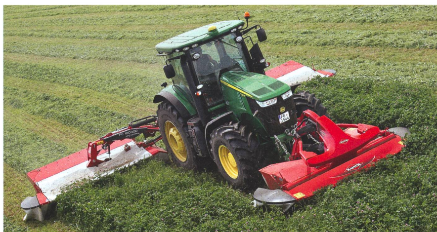
La combinaison de fauche triple FC 3525 à l'avant et FC 10030 à l'arrière est équipée d'un lamier OptiDisc et d'une sécurité antisurcharge Protectadrive.
