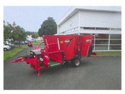
La remorque mélangeuse Profile 80 Compact dispose d'une voie étroite.
