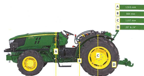
Avec les nouveaux modèles 5GL, John Deere lance des tracteurs bas de 75 ou 85 chevaux.
