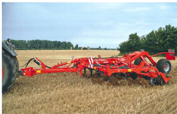
Les cultivateurs à trois rangs Cultimer L (ici le 4000) conviennent pour un travail superficiel, moyen et profond jusqu'à 35 cm.
