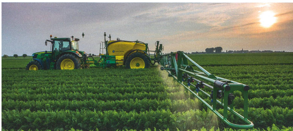
Les pulvérisateurs de la série M700 se voient dotés de rampes de 18 à 30 mètres.
