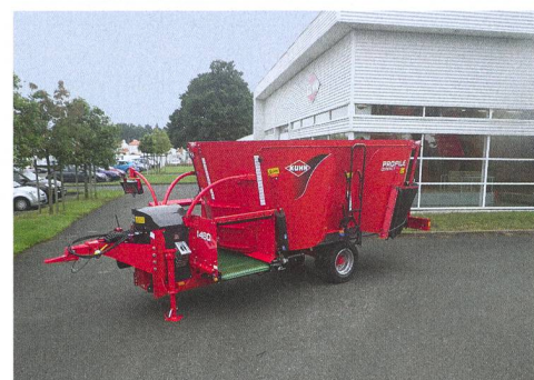
La remorque mélangeuse Profile 80 Compact dispose d'une voie étroite.
