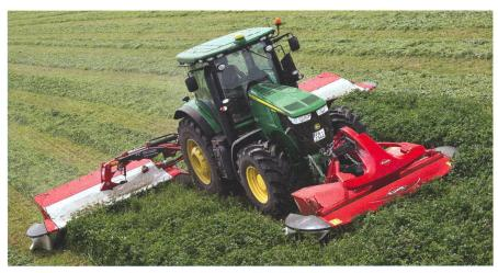
La combinaison de fauche triple FC 3525 à l'avant et FC 10030 à l'arrière est équipée d'un lamier OptiDisc et d'une sécurité antisurcharge Protectadrive.
