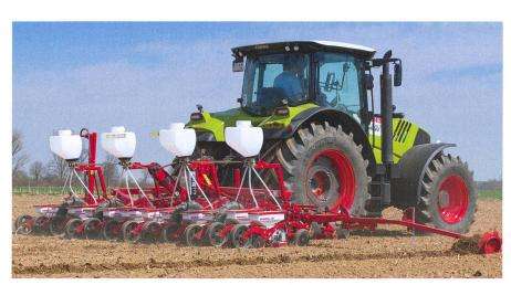
Avec l'application « GEOseed », la mise en place des graines peut se faire en parallèle ou en quinconce sur la largeur de la machine.
