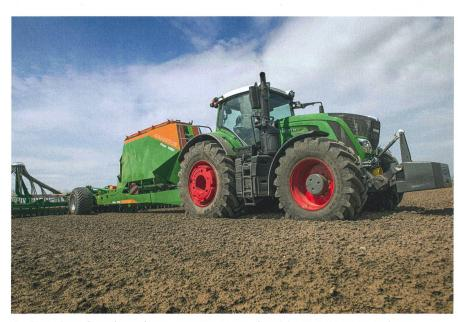
Fendt continue d'employer des moteurs Deutz pour les séries 800 et 900. Un turbocompresseur à deux paliers avec refroidissement intermédiaire, la recirculation des gaz d'échappement externe, un filtre à particules passif et un système RCS sont utilisés pour le niveau d'émissions 4.
