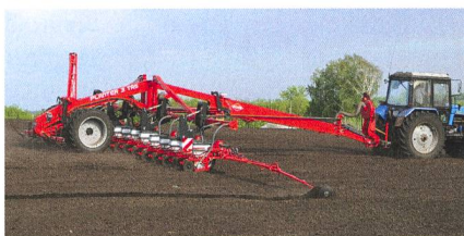
Le semoir monograine Planter 3 TRS d'une largeur de travail de 12 m nécessite une puissance du tracteur de 120 ch.
