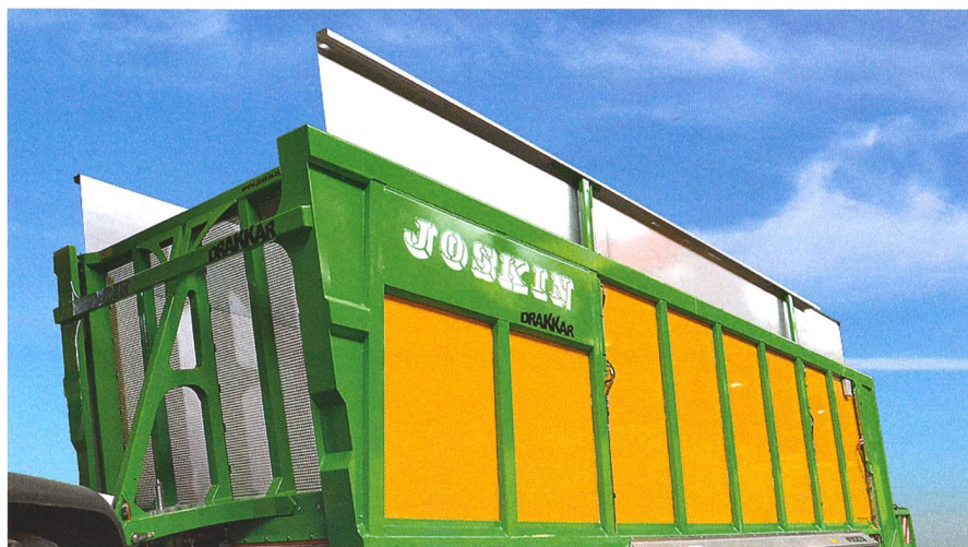
Il est désormais possible d'équiper la caisse polyvalente des modèles Drakkar de Joskin de rehausses hydrauliques. (Photo d'usine)
