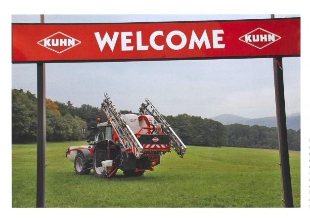
L'Altis 2002 a de nouvelles rampes qui peut être pliées en diagonale sur le côté de la machine. Elles ne dépassent donc pas sur le côté du tracteur pendant le transport (Photos d'usine et de Dominik Senn)
