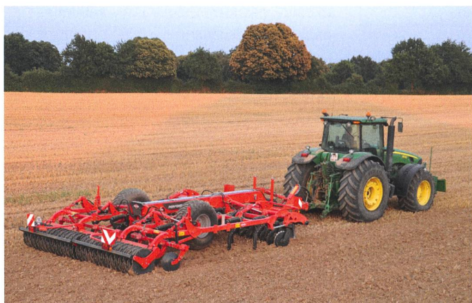
Un travail du sol en surface et en profondeur est possible en un passage après la récolte avec les cultivateurs combinés Performer 4000 (photo) et 5000.
