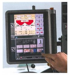
Plus besoin de quitter le tracteur: l'application «Spreader Set» permet de régler les quantités d'engrais à épandre d'une simple pression sur un bouton avec les épandeurs GEOspread.
