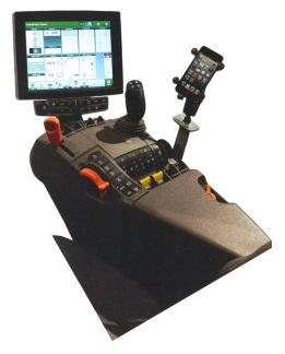
Dans les séries 7R/8R, le siège du conducteur de la nouvelle cabine Command-View-III peut tourner à 40° et est doté d'un nouvel accoudoir Command-Arm.
