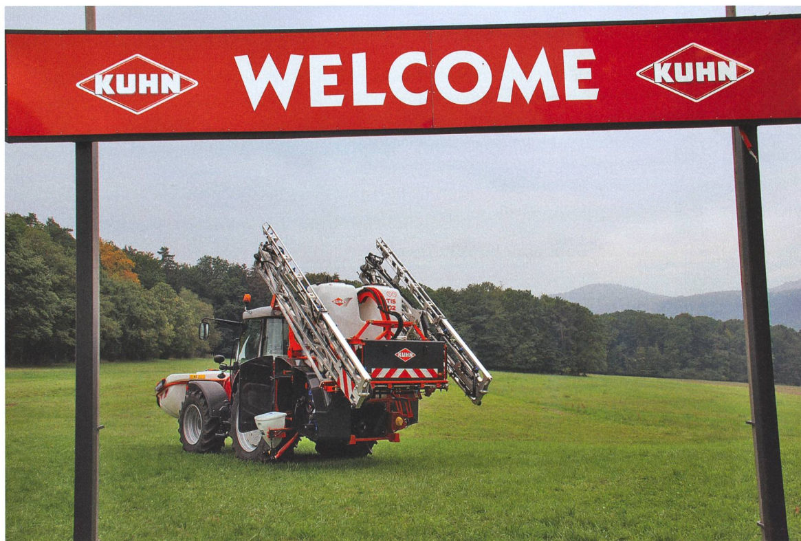
L'Altis 2002 a de nouvelles rampes qui peut être pliées en diagonale sur le côté de la machine. Elles ne dépassent donc pas sur le côté du tracteur pendant le transport (Photos d'usine et de Dominik Senn)
