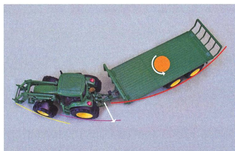
En raison de l'inertie de masse autour de son axe vertical, la remorque tend à garder une trajectoire linéaire. En braquant avec cette remorque à essieu(x) médian(s), des forces viennent s'exercer obliquement sur le timon, respectivement la chape d'attelage. (flèche blanche).
