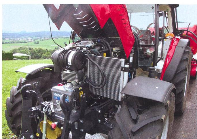
Les radiateurs peuvent se basculer à l'extérieur de manière à être très accessibles pour le nettoyage.
