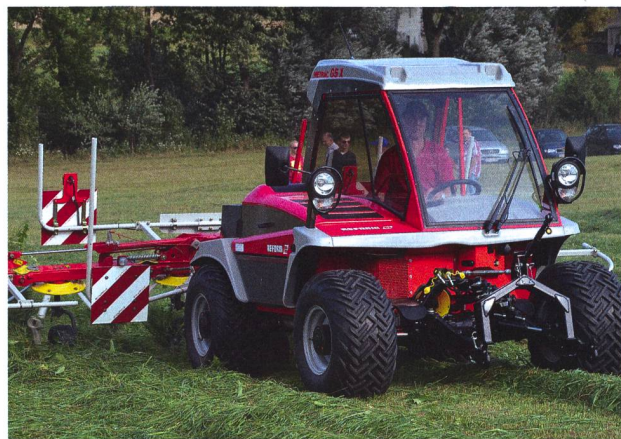
Metrac G5X : les faucheuses à deux essieux conviennent pour faucher, faner, andainer, tracter et réaliser de nombreux autres travaux. (Photo: Ruedi Hunger)
