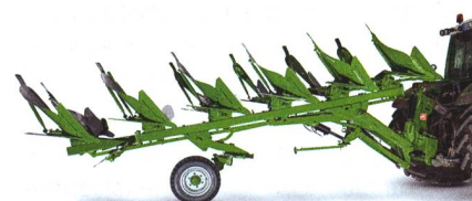
La roue d'appui se transforme aisément pour le transport.
