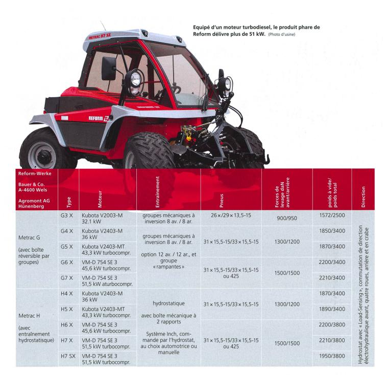
d'huile par minute, à une pression maximale de 195 bar. Le relevage des modèles G6/7 et H6/7 dispose d'un système de compensation du poids automatique et d'amortissement des vibrations. Entièrement équipées, ces machines sont dotées de dix raccords avant et de huit arrière pour les appareils hydrauliques.
