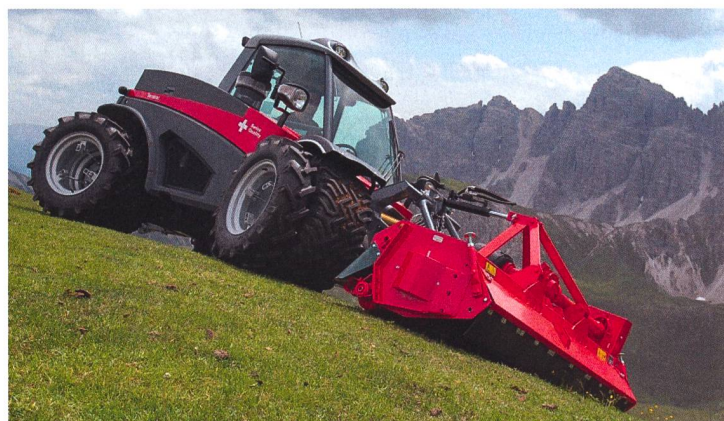
Aebi TT 280 : de grosses débroussailluses peuvent également être utilisées grâce à des puissances atteignant 80 kW. (Photo d'usine)
