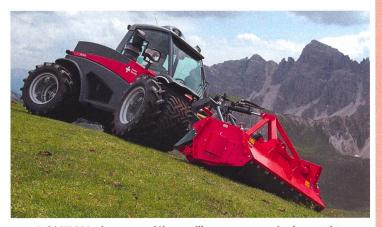
Aebi TT 280: de grosses débrousailleuses peuvent également être utilisées grâce à des puissances atteignant 80 kW. (Photo d'usine)
