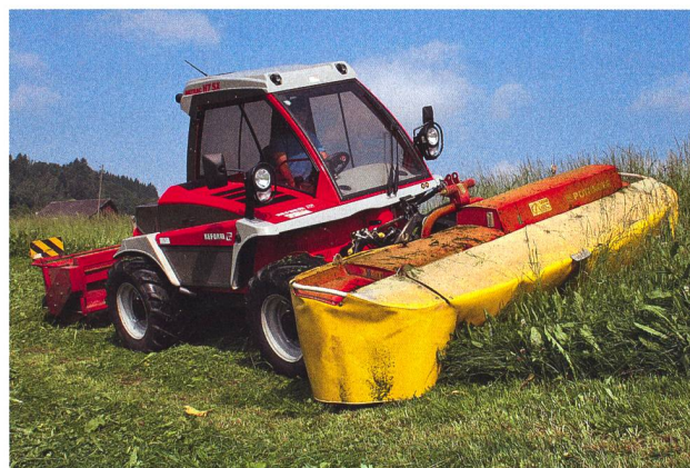
Metrac H7 : les faucheuses à deux essieux assurent une excellente visibilité sur les outils frontaux.
