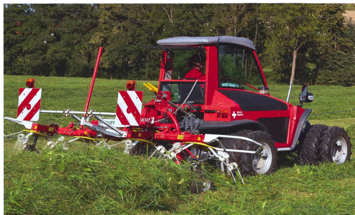
AEBI TT 205 : bien que l'attelage frontal prédomine, les faucheuses à deux essieux sont actuellement aussi fréquemment équipées d'un système hydraulique arrière.
