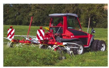
AEBI TT 205: bien que l'attelage frontal prédomine, les faucheuses à deux essieux sont actuellement aussi fréquemment équipées d'un système hydraulique arrière.
