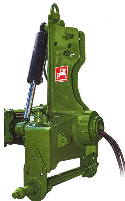
Les tuyaux hydrauliques sont protégés durant le processus de retournement grâce à l'arbre creux.
