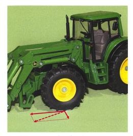
Danger accru dans les virages Des forces longitudinale et transversale s'exercent au niveau des roues du tracteur. Elles s'ajoutent à la mesure des vecteurs du parallélogramme des forces. Lors d'un freinage en courbe, le véhicule risque de perdre son adhérence et de commencer à glisser.
