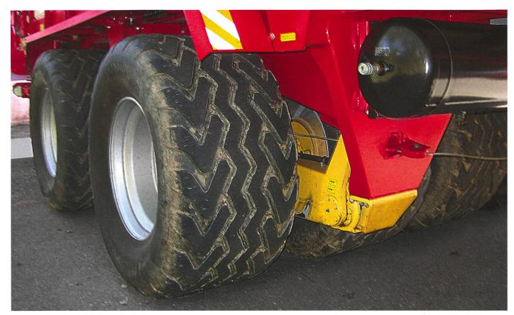
Le profil des pneus et les freins se révèlent déterminants quant à la tenue dans les pentes. Le risque de glissement latéral s'est encore réduit suite au choix du profil AS sur cet essieu pendulaire multiple. L'important est de munir toutes les roues de freins, faute de quoi les forces nécessaires ne peuvent être transmises au sol. Cela vaut aussi pour les trajets routiers. (Photos: Ruedi Gnädinger)
