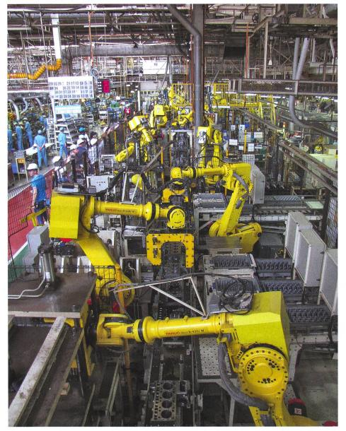
A Tsukuba, 30 robots exécutent le montage des moteurs diesel. (Photos: Ruedi Burkhalter)
