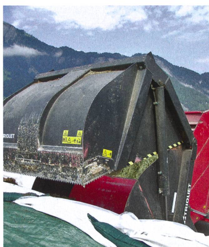
La conception des dispositifs d'autoremplissage est assez complexe, à la mesure des besoins en entretien. Ici une remorque mélangeuse verticale. (Photos : Ruedi Hunger)
