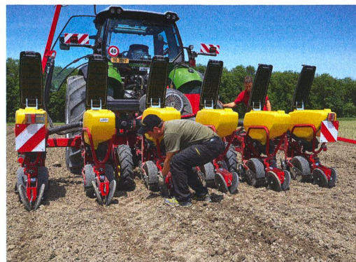
Un capteur de remplissage sur le troisième organe de semis contrôle la quantité de semences et déclenche l'alarme lorsque la réserve s'épuise.
