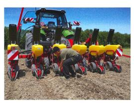
Un capteur de remplissage sur le troisième organe de semis contrôle la quantité de semences et déclenche l'alarme lorsque la réserve s'épuise.
