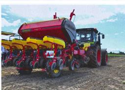
Le repli des secteurs de rampe de la machine portée peut se faire manuellement ou hydrauliquement. Une largeur de transport de 3 m est ainsi atteinte avec un espace interligne de 75 cm et moins.
