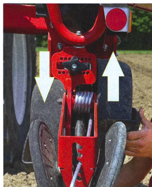
Les roulettes tandem égalisent les irrégularités du sol, un système de compensation pendulaire étant disposé entre les deux roues de jauge.
