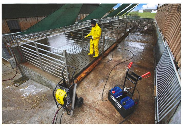
La pression et le débit d'eau sont deux paramètres importants. Pour le nettoyage des écuries, on fera subsidiairement appel à de la mousse produite à basse pression ou à des détergents chimiques (Photo d'usine)
