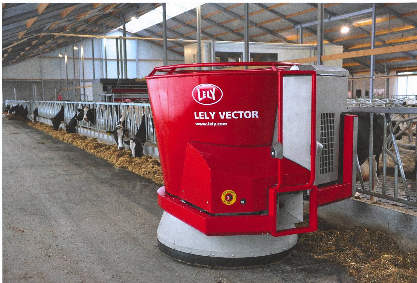
Ce robot d'affouragement automatique remplit plusieurs missions. La hauteur du fourrage restant est mesurée par capteur et détermine la distribution, les restes étant repoussés en même temps. (Photos d'usine)
