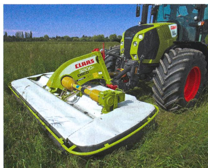
Les nouvelles faucheuses frontales Disco 3200 sont protégées par un cadre pare-chocs.
