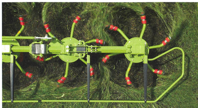
Les dents fixées tangentiellement sur les bras font partie du concept « Max Spread ».
