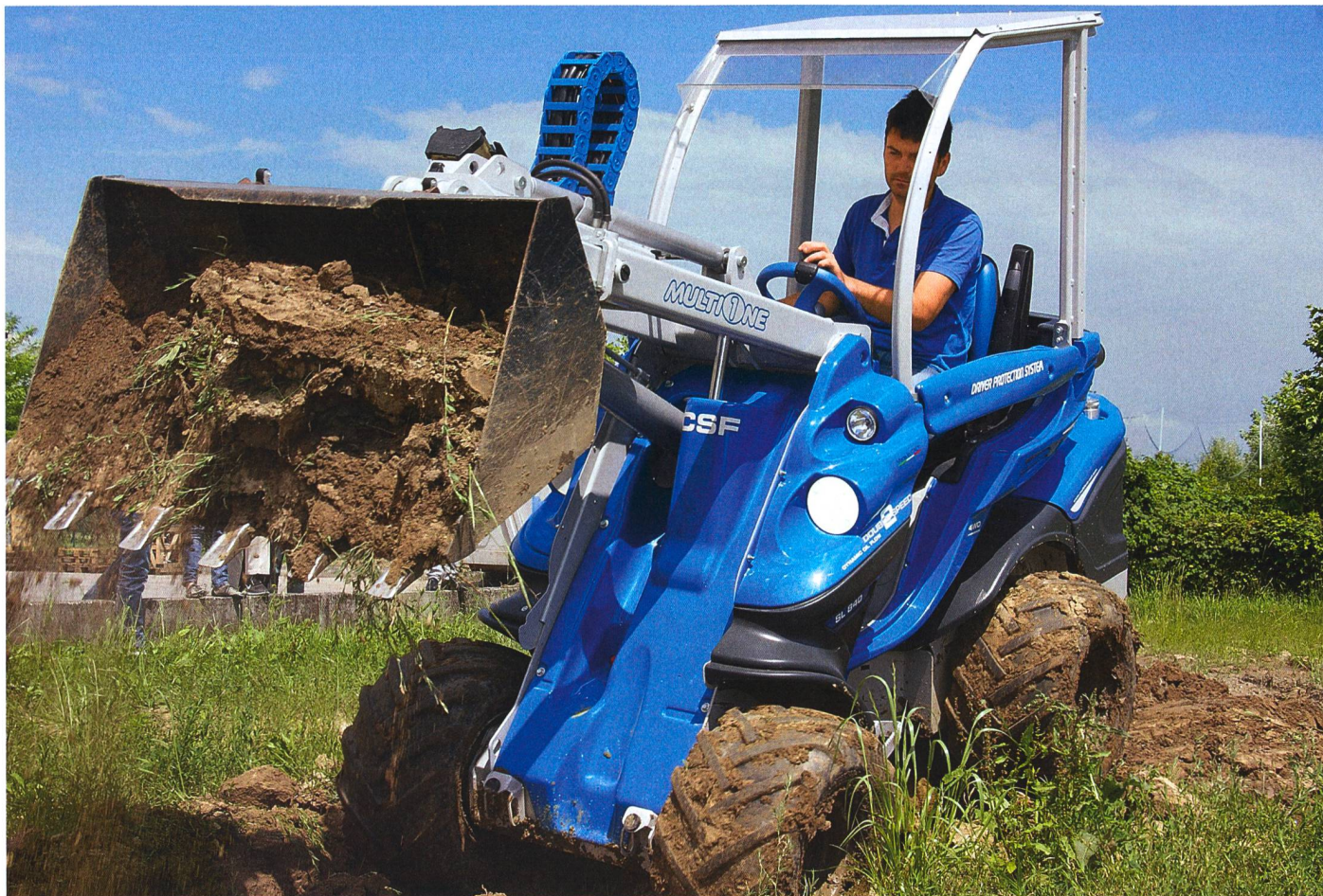
Performances optimales du modèle vedette SL840 DTP avec ses deux plages de vitesse. Le bras télescopique atteint une hauteur de trois mètres. (Photos: Ueli Zweifel)
