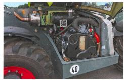
Les grands modèles sont équipés d'un filtre à particules.
