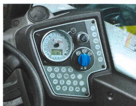
La cabine réaménagée gagne 10 cm de largeur par rapport aux modèles précédents. La sélection des modes de direction est modifiable grâce à un bouton rotatif (image de droite).
