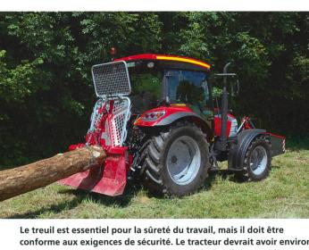
conforme aux exigences de sécurité. Le tracteur devrait avoir environ 12 chevaux par tonne de force de traction du treuil. Son poids est déterminant.
