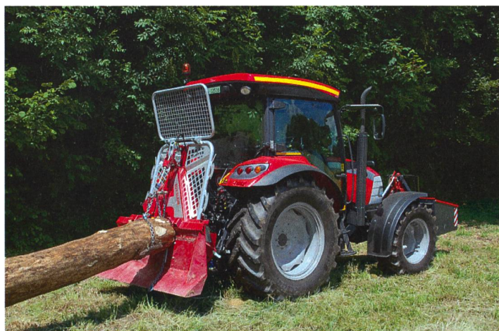
Le treuil est essentiel pour la sûreté du travail, mais il doit être conforme aux exigences de sécurité. Le tracteur devrait avoir environ 12 chevaux par tonne de force de traction du treuil. Son poids est déterminant.
