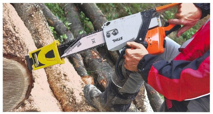
Le « pied » du boîtier du PowerSharp est appuyé contre un support solide et la machine est lancée quelques secondes à plein régime. (Photos: EFS)
