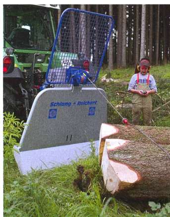
Grâce à la radiocommande, l'opérateur reste en sécurité hors de la zone de danger.
