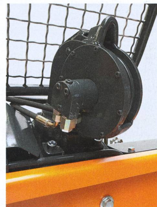
Ce système de déroulage à assistance hydraulique sert aussi de frein d'enroulement.
