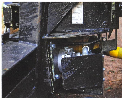
Les treuils hydrauliques devraient disposer de leur propre alimentation hydraulique.
