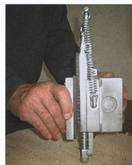
La cale du frein à disque se desserre automatiquement sous l'effet de la traction.
