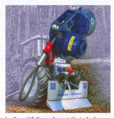
Le dispositif d'enroulement électrohydraulique maintient le câble tendu en permanence.
