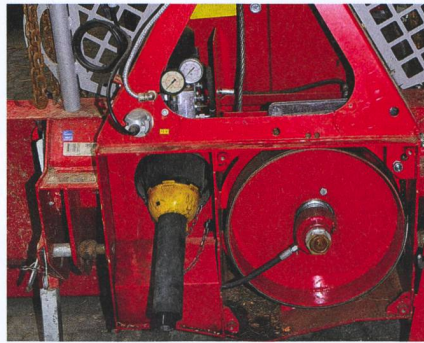
Des manomètres permettent de surveiller la pression dans les organes sur ce treuil.
