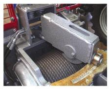
Grâce au bras articulé, le câble est quidé avec un angle de 90 degrés sur le tambour.
