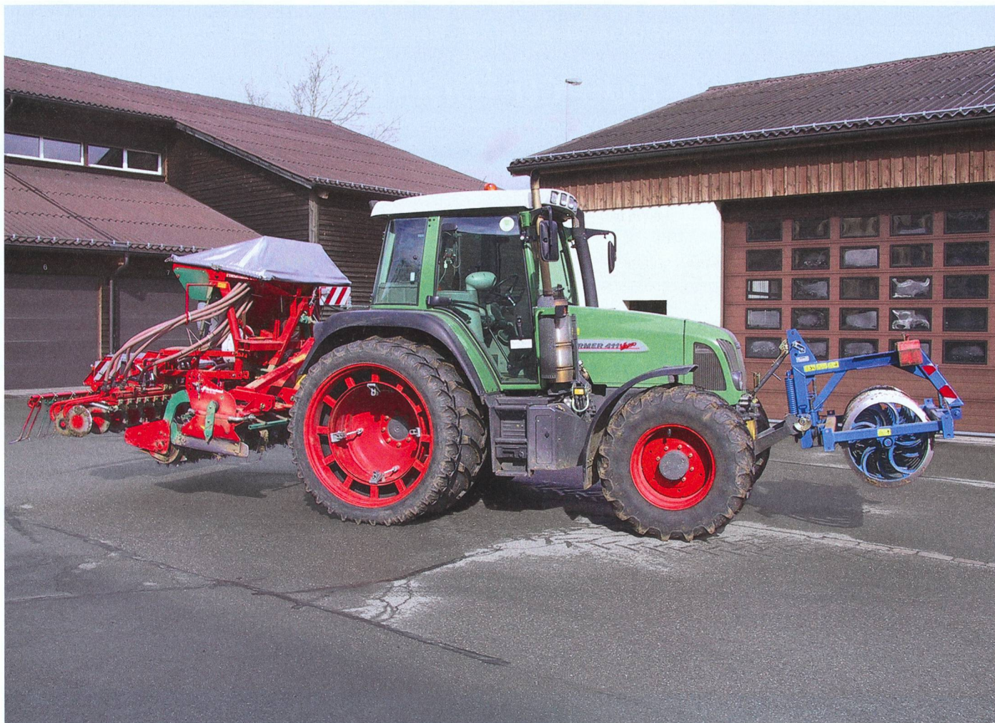
Des outils frontaux et arrière permettent une répartition régulière du poids sur le tracteur. (Photo : Agroscope ART)
