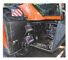
Facilement accessible, le caisson pour les batteries et les vannes hydrauliques sert aussi de caisse à outils.
