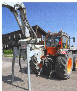
Le système PSA permet de démonter la grue en une dizaine de minutes.
