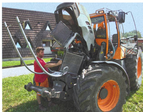
Moteur et radiateurs restent totalement accessibles pour les travaux d'entretien
