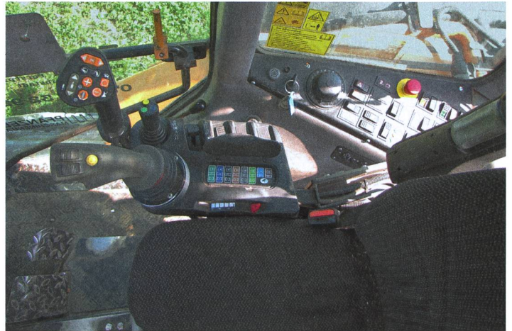
Sur l'accoudoir droit, à côté du joystick principal, le Multicontroller et les commandes des différents outils.
