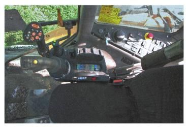
Sur l'accoudoir droit, à côté du joystick principal, le Multicontroller et les commandes des différents outils.
