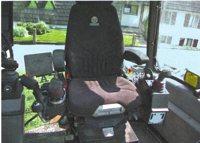
A tout moment, le siège et toutes les commandes peuvent pivoter électriquement sur 220°. (Photos : Ruedi Burkhalter)
