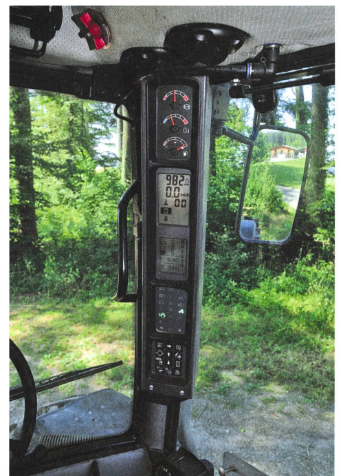
Le montant droit de la cabine accueille l'écran et les cadrans.
