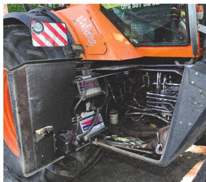
Facilement accessible, le caisson pour les batteries et les vannes hydrauliques sert aussi de caisse à outils.
