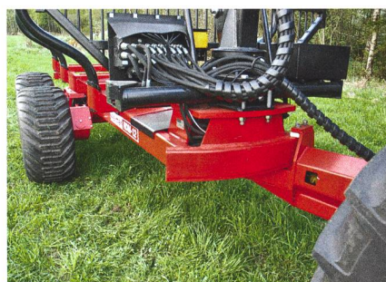
Bien que nécessitant plus de pièces mobiles sur le véhicule, un timon articulé assure une meilleure maniabilité sur les places de retournement et dans les layons.
