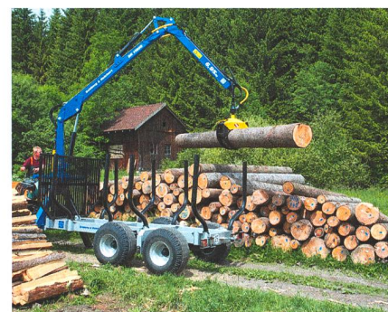
En sus du rayon d'action et de la capacité de levage souvent évoqués, la qualité du pivot, la présence d'un bras articulé, avec ou sans levier, ou d'un bras télescopique sont autant de détails importants à l'usage d'une grue.
