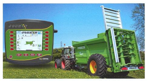
Grâce au terminal, l'opérateur peut visionner des informations essentielles comme la vitesse d'avancement du tapis, la hauteur d'ouverture de la porte et le débit d'huile fourni au moteur hydraulique qui entraîne le tapis.
