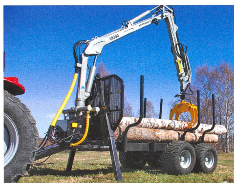
Les supports en A télescopiques ont besoin de moins de place pour se poser.
