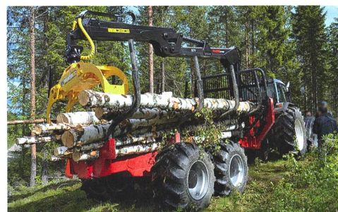
Le nombre de ranchets ou de poteaux, extensible dans la plupart des remorques, dépend de l'assortiment à transporter.
