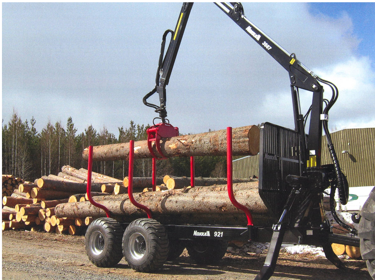
Remorque de débardage avec châssis classique à traverses et essieu boggie: la grue est montée sur la remorque et repose sur des béquilles flap-down. Elle est pilotée depuis la cabine du tracteur. (Photos: LDD/Ruedi Hunger)
