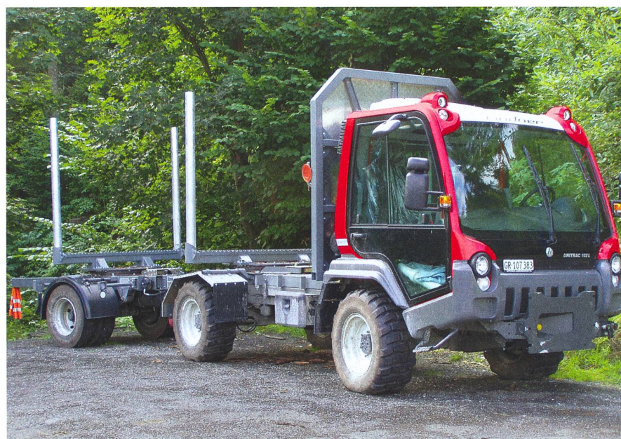
Les transporteurs avec triqueballe pour bois longs comblent une lacune dans l'offre des divers véhicules de transport.
