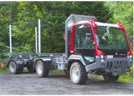
Les tansporteurs avec triqueballe pour bois longs comblent une lacune dans l'offre des divers véhicules de transport.
