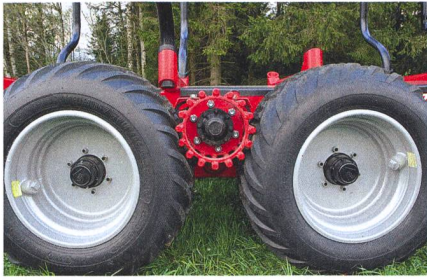
Le système d'entraînement à roue cannelée appuie sur les pneumatiques. Il est efficace. La vitesse est limitée, entre 2 et 5 km/h.
