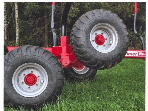
Les essieux boggies ont fait leurs preuves. Pour franchir les obstacles, ils doivent disposer de suffisamment de débattement vers le haut (attention aux ranchets !), ce qui élève le centre de gravité du véhicule.
