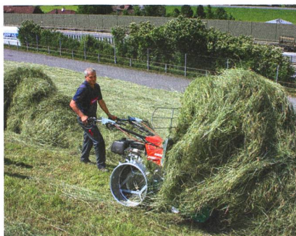
Le Twister met à profit la gravité pour déposer le fourrage à gauche ou à droite.
