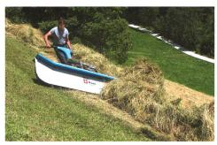
Sur le Hill-Rake de la maison Erni, le fourrage est pris en charge par des fourches à ressorts.
