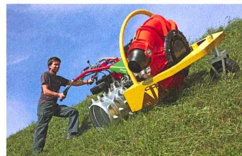
Le Hay-Blower, une puissante souffeuse avec moteur intégré de chez Itin & Hoch.
