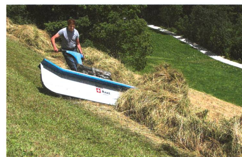
Sur le Hill-Rake de la maison Erni, le fourrage est pris en charge par des fourches à ressorts.
