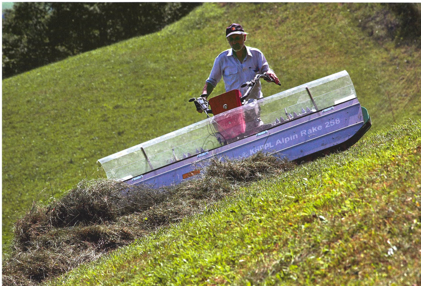
L'Alpin-Rake de la marque Köppl est équipé de fourches rigides. (Photos: Konrad Merk/LDD)
