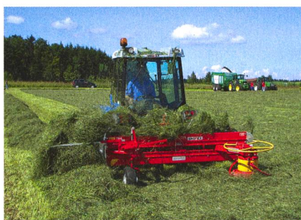
Les andaineurs à ruban ne travaillent que d'un côté et la prise en charge du fourrage n'est pas toujours optimale.
