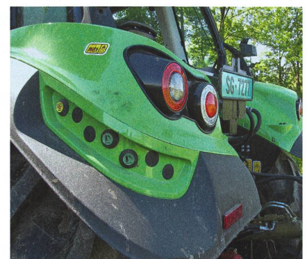
Les interrupteurs situés sous les feux arrière à LED commandent quatre fonctions.
