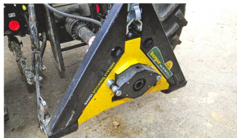
Des raccords rapides sont fixés sur le triangle d'attelage. La tête d'attelage est maintenue par des ressorts et peut se déplacer et se centrer horizontalement.
