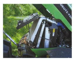
Les quatre éléments du radiateur se déplient pour le nettoyage.
