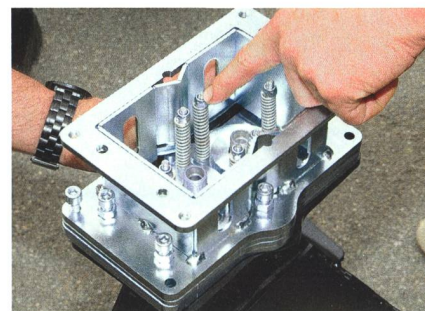
Des raccords rapides sont fixés sur le triangle d'attelage. La tête d'attelage est maintenue par des ressorts et peut se déplacer et se centrer horizontalement.
