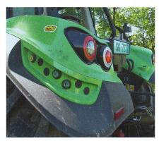
Les interrupteurs situés sous les feux arrière à LED commandent quatre fonctions.
