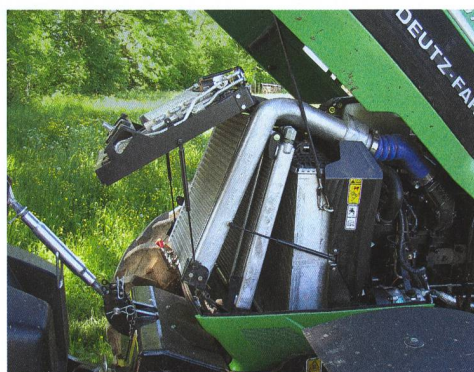
Les quatre éléments du radiateur se déplient pour le nettoyage.
