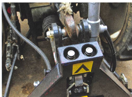
Des raccords rapides sont fixés sur le triangle d'attelage. La tête d'attelage est maintenue par des ressorts et peut se déplacer et se centrer horizontalement.
