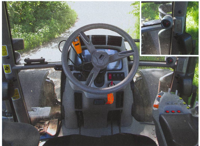
La cabine offre un large champ de vision. Un afficheur supplémentaire est intégré au montant droit (en médaillon).
