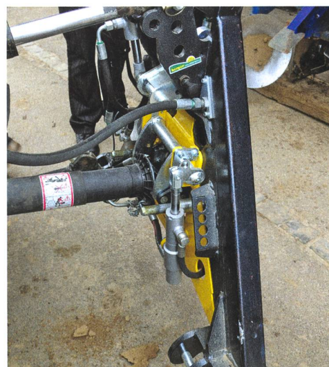
Un vérin hydraulique est disponible pour le verrouillage et la prise de force.
