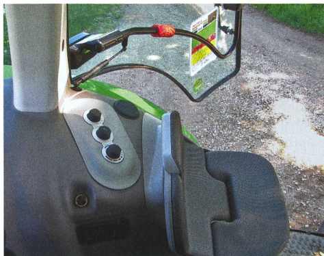
La commande de climatisation est placée derrière le siège du passager.
