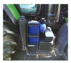
Echelle de droite, support du réservoir à diesel, caisse à outils, coffre de la batterie.
