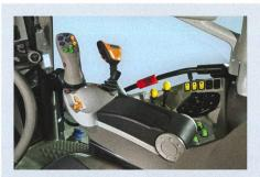
Le joystick sur l'accoudoir de la version «P» et le levier principal dans sa nouvelle livrée.
