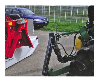
Les appareils peuvent également être couplés avec des triangles sans dispositif pour prise de force.
