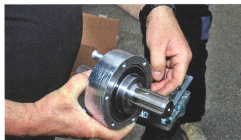
Après le verrouillage du triangle d'attelage, la prise de force est poussée hydrauliquement.
