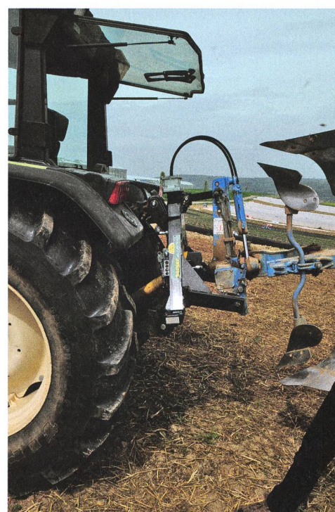
Le centre de gravité de la charrue a été déplacé loin à l'arrière.
