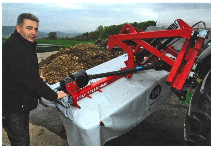
Guido Berger démontre comment la transmission a été déplacée vers l'arrière de la faucheuse frontale.
