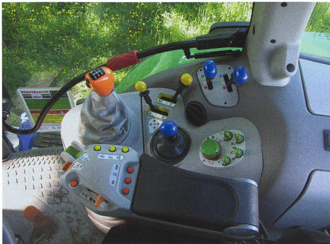
L'accoudoir et la console latérale (ici encore l'ancien levier) garantissent un espace de travail bien agencé.
