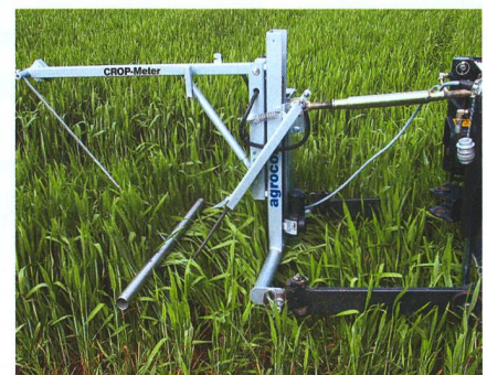
Le Crop-Meter développé à l'ATB Potsdam détermine la biomasse du peuplement à partir de la résistance à la flexion des tiges des plantes. (Photo: ATB Potsdam/Gebbers)
