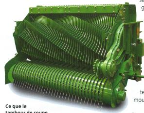
Ce que le tambour de coupe est à l'ensileuse, le rotor de coupe l'est à l'autochargeuse de haute performance. La forme incurvée permet de réduire les charges de pointe.
