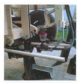
Le pH-Manager de Veris permet la mesure du pH du sol. Pour ce faire, un cône métallique (photo ci-dessous) passe dans le sol. L'échantillon de sol est périodiquement prélevé sur la plaque arrière, et son pH est mesuré au moyen d'électrodes.
