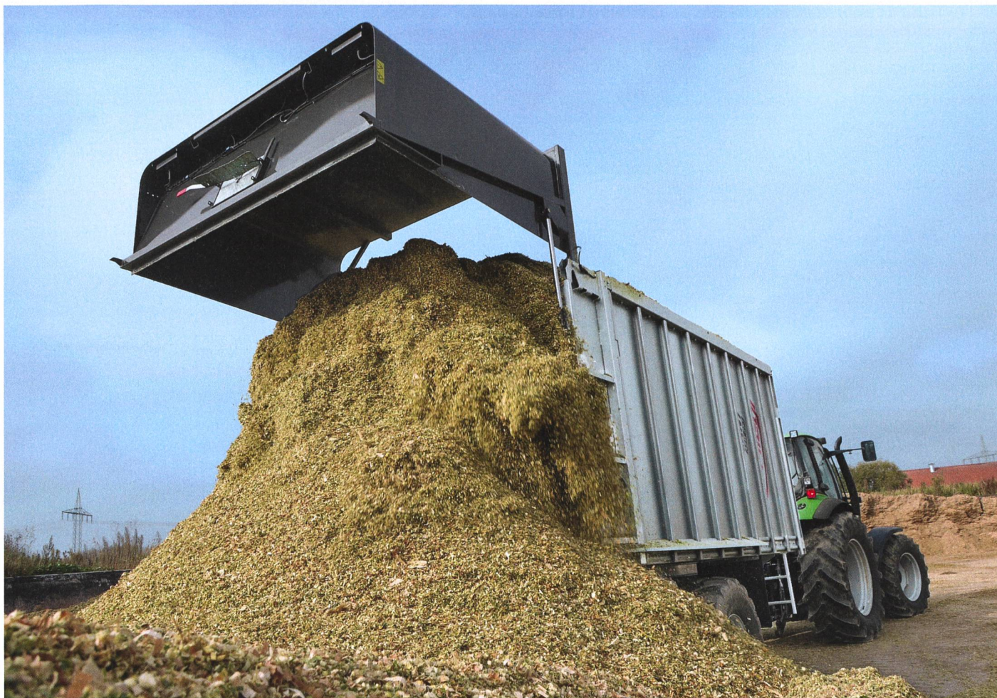
La technique à fond poussant est adaptée au transport de différents matériaux en vrac. Le centre de gravité bas et la vidange rapide figurent parmi les avantages de cette remorque. (Photos: Ruedi Hunger et photos d'usine)
