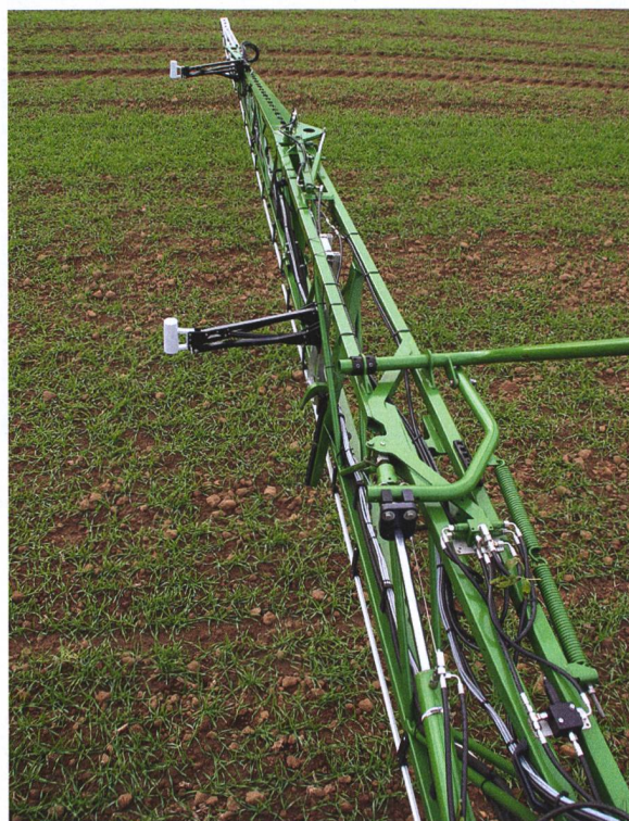
Le capteur P3 placé sur la rampe de pulvérisation mesure la biomasse des céréales avec des ultrasons. (Photo: Agri Con GmbH)
