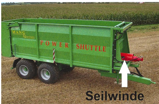
Mang vide ses remorques à fond poussant avec un treuil, ce qui évite l'utilisation de cylindres plus ou moins longs.
