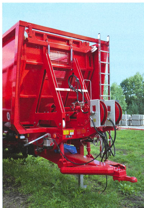
La technique à fond poussant implique une grande complexité technique, ce qui entraîne également un poids supérieur.
