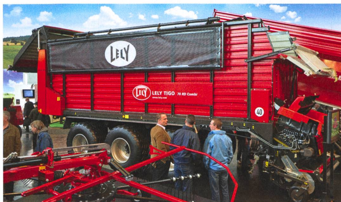
La Lely Tigo travaille avec un pick-up libre, et le rotor d'alimentation doit être conçu, aux dires du constructeur, avec une plus petite entaille.
