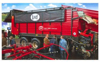
La Lely Tigo travaille avec un pick-up libre, et le rotor d'alimentation doit être conçu, aux dires du constructeur, avec une plus petite entaille.
