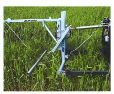
Le Crop-Meter développé à l'ATB Potsdam détermine la biomasse du peuplement à partir de la résistance à la flexion des tiges des plantes. (Photo: ATB Potsdam/Gebbers)
