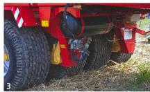
maximale autorisée. Lors du déchargement, la paroi avant se déplace vers l'arrière avec le fond mouvant et amène l'ensemble du fourrage à l'arrière de la machine. En fin de compte, la remorque est raccourcie d'environ 1 m et donc plus maniable.
