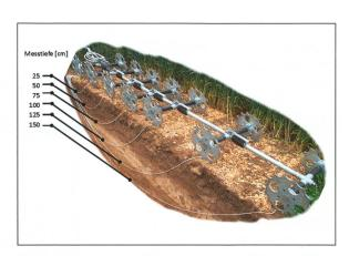
A partir des mesure du Geophilus electricus, des cartes des sols en trois dimensions à haute résolution peuvent être créées. Les différentes caractéristiques du sol sont représentées en couleur.
