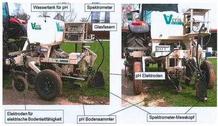
La société « Veris Technologies » offre une plate-forme modulaire, plusieurs techniques de mesure au sol pouvant être effectuées en même temps en roulant à travers le champ.
