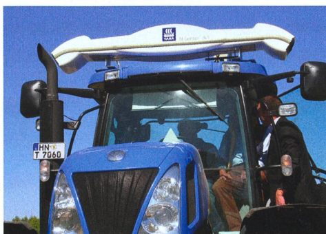
Les capteurs de mesure de l'azote Yara travaillent en diagonale à partir du toit du tracteur et couvrent ainsi un champ de mesure représentatif. (Photo: Agri Con GmbH)
