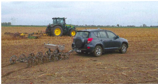
Le capteur au sol roulant «Geophilus electricus» en test de lecture sur une terre arable. (Photos: Geophilus GbR)
