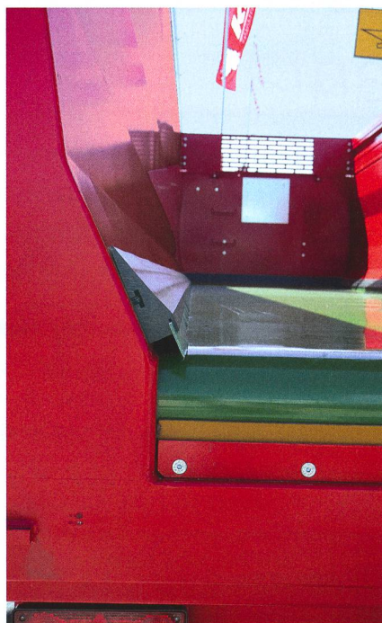
La clé de l'étanchéité d'une remorque à bande roulante se situe au niveau de celle des lèvres latérales.
