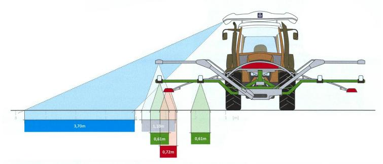
Le montage des capteurs sur le toit du tracteur ou à l'avant a une incidence sur le champ de mesure. Ce fait doit être pris en compte dans les logiciels d'interprétation de données. (Graphique: Agri Con GmbH)
