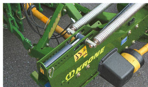
La tension des ressorts de cette faucheuse Krone se règle de façon hydraulique.
