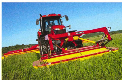
Cette faucheuse frontale Fella a les mêmes suspensions que les tractées. type type(Fell'image).
