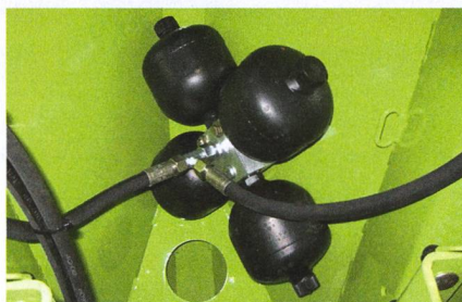
Plusieurs accumulateurs réagissent plus vite qu'un gros selon Claas.
