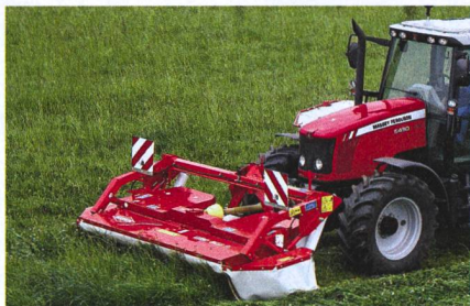
Cette faucheuse frontale Kuhn est équipée d'une suspension tractée.
