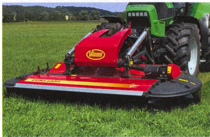
Vicon/Kverneland a déplacé les ressorts vers l'extérieur pour davantage de stabilité.
