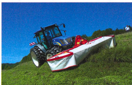
Polytrac : la faucheuse s'incline de manière optimale dans le sens de déplacement.
