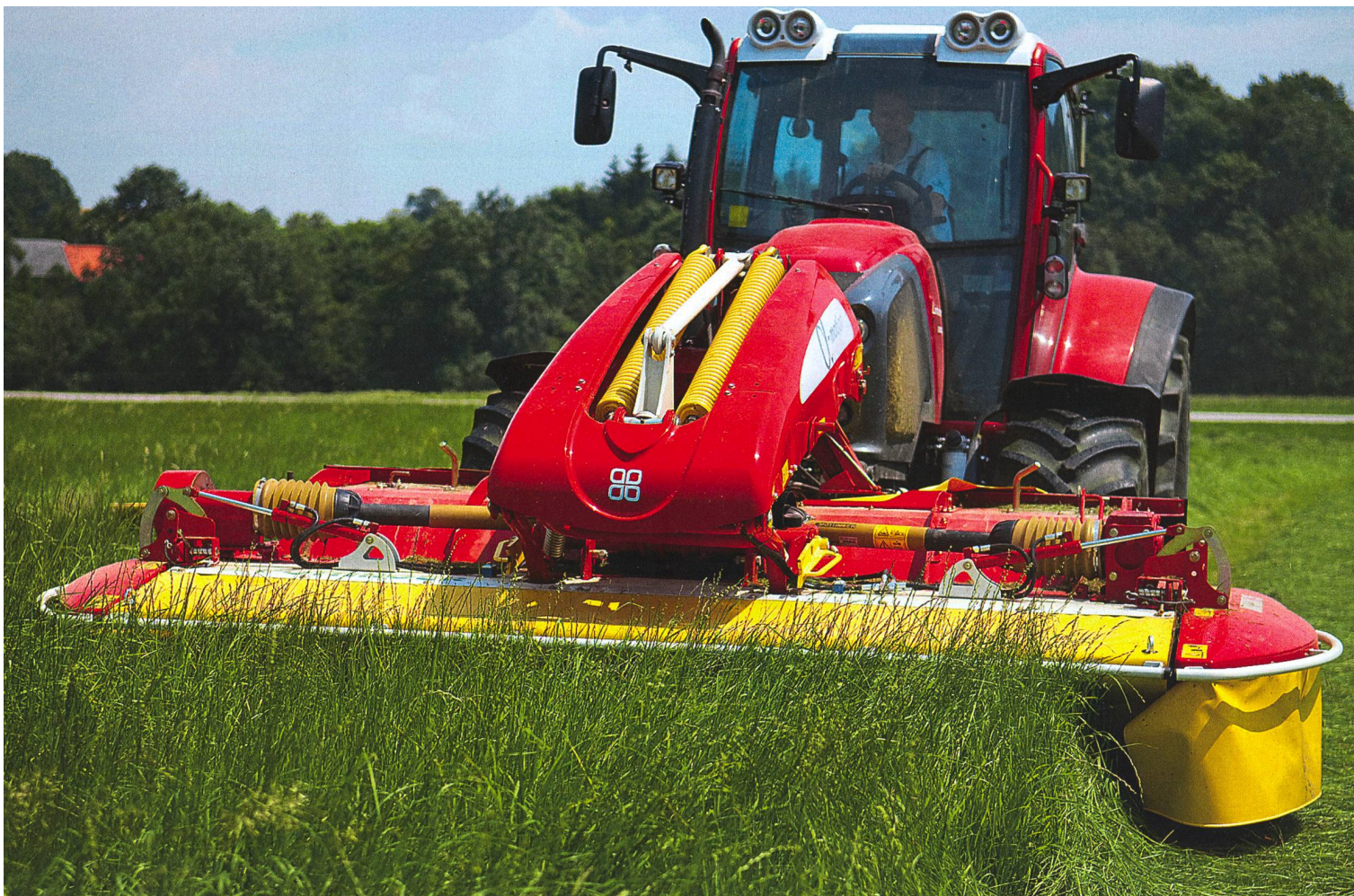
Le dispositif de décharge «alpha-motion» de Pöttinger travaille avec deux logs ressorts en acier. (mäd)
