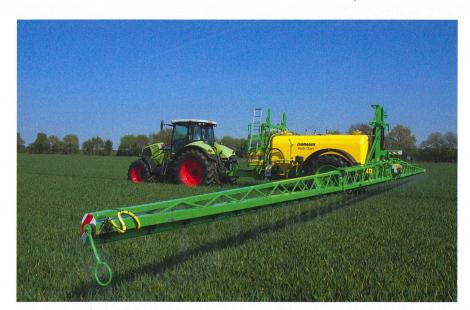
Un moment de force précis appliqué à la rampe permet d'en contrôler les oscillations horizontales et verticales, même sur de grandes largeurs de travail.
