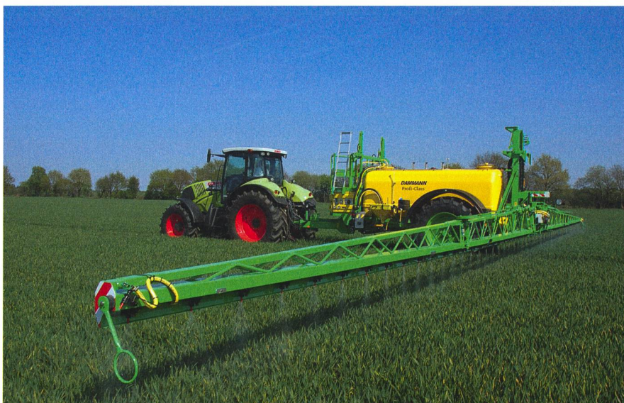
Un moment de force précis appliqué à la rampe permet d'en contrôler les oscillations horizontales et verticales, même sur de grandes largeurs de travail.
