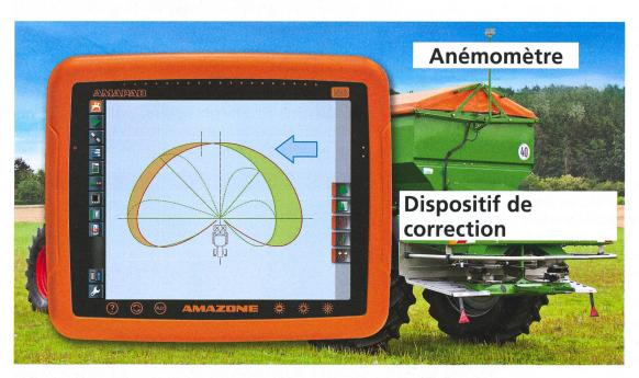
D'une collaboration entre scientifiques et industrie est né un dispositif de correction des effets du vent pour épandeurs centrifuges.
