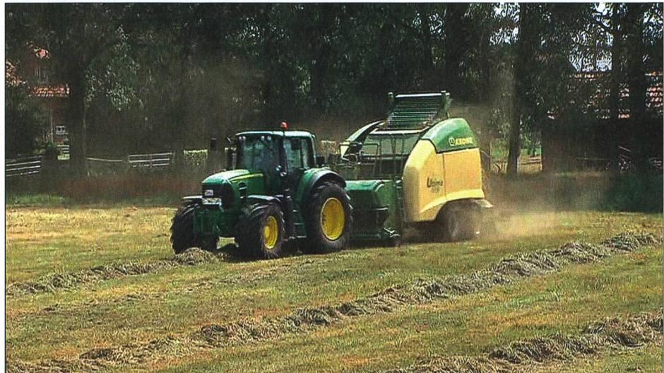
**Taille et densité de la balle, début du liage, balle prête : ces informations sont transmises au conducteur du tracteur qui doit, sur la base de ces données, effectuer jusqu'à 60 interventions par heure sur le fonctionnement du véhicule. Avec un TIM, le système prend en charge ces informations et conduit le tracteur. Son chauffeur reste concentré pour surveiller le déroulement des opérations.** (Photo : Horstmann Krone)
