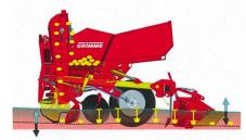
En utilisant le TIM, cette planteuse Grimme dépose les plants à une profondeur constante, en corrigeant l'effet de l'allègement de la trémie et ceux liés aux conditions du sol. Le relevage du tracteur s'adapte automatiquement, sans intervention du conducteur. (Image: Grimme/Lemken)
