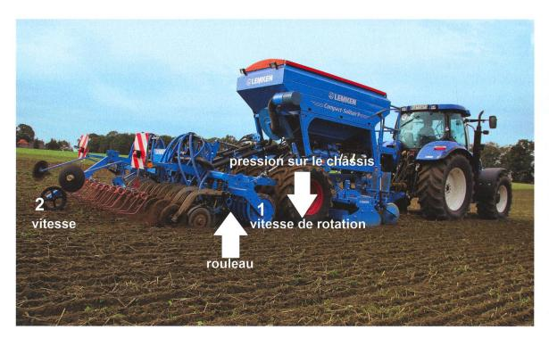
L'image montre un combiné de semis traîné, avec rouleau. En (1), le capteur mesurant la vitesse de rotation du rouleau et, en (2), la mesure de la vitesse d'avancement effective. Le TIM calcule le taux de patinage et utilise le différentiel vitesse d'avancement/ patinage de l'outil pour reporter une partie du poids du rouleau sur le châssis. Tout se fait. bien sûr, automatiquement, sans intervention du conducteur. (Photo:
