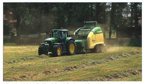
Taille et densité de la balle, début du liage, balle prête: ces informations sont transmises au conducteur du tracteur qui doit, sur la base de ces données, effectuer jusqu'à 60 interventions par heure sur le fonctionnement du véhicule. Avec un TIM, le système prend en charge ces informations et conduit le tracteur. Son chauffeur reste concentré pour surveiller le déroulement des opérations. (Photo: Horstmann Krone)
