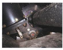
◆ Le frein de stationnement est actionné par un accumulateur à ressort pneumatique.
