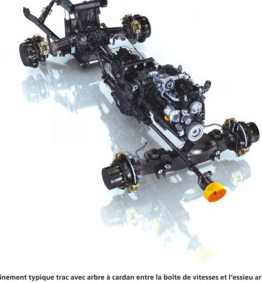
Entraînement typique trac avec arbre à cardan entre la boîte de vitesses et l'essieu arrière.On voit aussi l'entraînement commun des prises de force avant et arrière.
