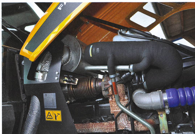
Le catalyseur à oxydation est placé sous le capot, le catalyseur SCR dessous à droite devant la cabine (pas visible ici).
