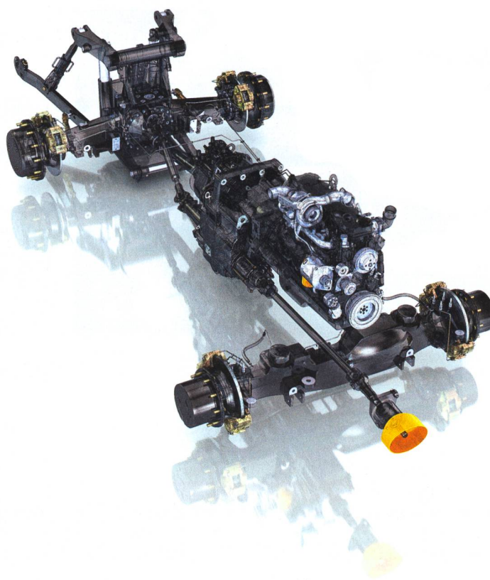
Entraînement typique trac avec arbre à cardan entre la boîte de vitesses et l'essieu arrière. On voit aussi l'entraînement commun des prises de force avant et arrière.
