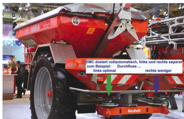
Epandeur High-Tech avec self control électronique du débit massique (EMC). La quantité d'engrais dans les zones limitrophes est adaptée automatiquement en fonction de la forme des parcelles.
