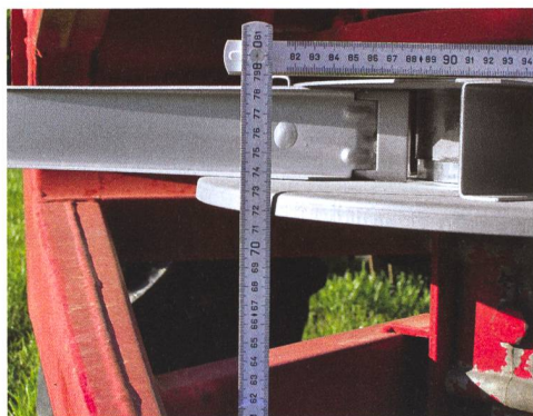
La bonne distance du disque d'épandage est déterminante pour la qualité de travail. Cette mesure figure dans le manuel d'utilisation.
