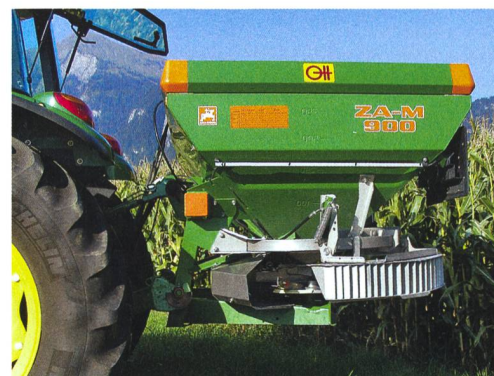
Les limites des champs posent problème. Ce système de bordure dirige le flux d'engrais spécifiquement en délimitant une zone précise.
