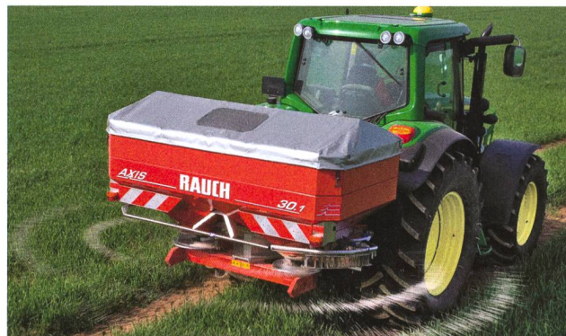
Les constructeurs les plus connus dotent majoritairement leurs épandeurs de technologie GPS. Par ailleurs, ils sont de plus en plus souvent compatibles ISOBUS.
