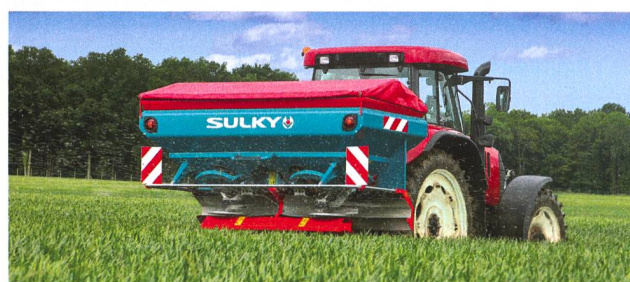
Les épandeurs à pesage peuvent être équipés d'un système électronique dépendant de la vitesse afin d'adapter automatiquement la quantité.
