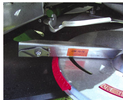
Les palettes d'éjection sont réglables en longueur et en angle, ce qui permet de s'adapter aux caractéristiques des engrais divers.
