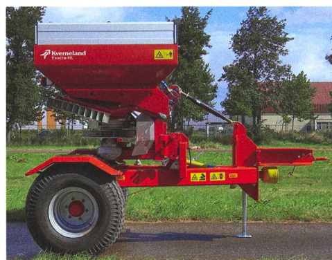
Les gros volumes de chargement nécessitent des tracteurs de plus en plus puissants. Les châssis simples facilitent les choses et permettent que les épandeurs remorqués soient adaptés aux petits tracteurs.
