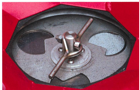
Le brasseur et le disque des épandeurs simples tournent au même régime.
