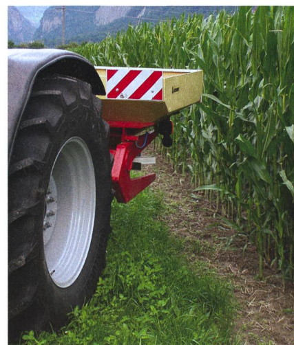
Les épandeurs d'engrais sont souvent plus larges que le tracteur. Une bonne signalisation s'avère alors indispensable.
