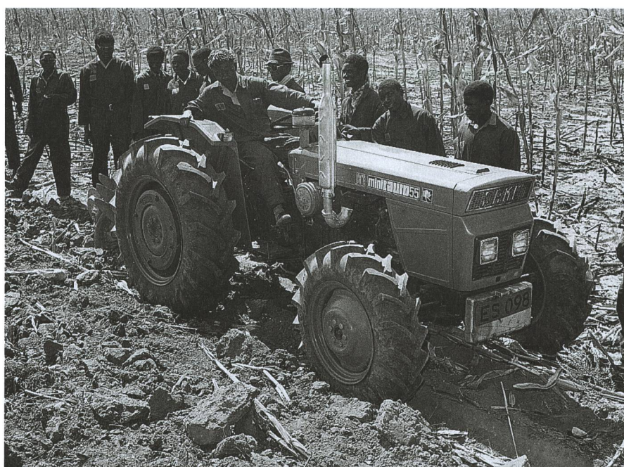
Un Same Minitauro en Afrique, dans les années 1960: le refroidissement à air est apprécié en région sèche.
