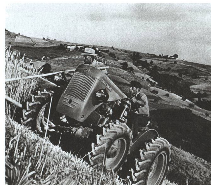
Same DA 25, premier tracteur à traction intégrale, en 1952. Il dispose d'un moteur 2-cylindres de 25 chevaux.
