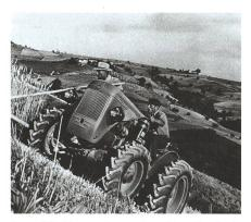
Same DA 25, premier tracteur à traction intégrale, en 1952. Il dispose d'un moteur 2-cylindres de 25 chevaux.
