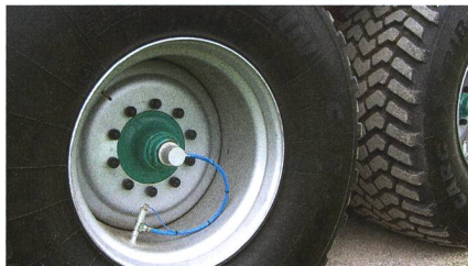
Les tracteurs et les remorques lourds doivent être munis d'un dispositif de régulation de la pression des pneus pour plus d'efficacité.
