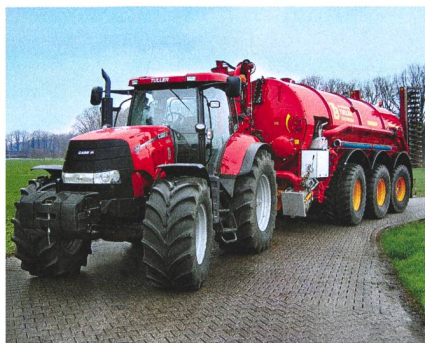
Lorsque ce tank à lisier quitte la route, deux facteurs sont à considérer : son poids et la fréquence des passages.
