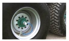
Les tracteurs et les remorques lourds doivent être munis d'un dispositif de régulation de la pression des pneus pour plus d'efficience.
