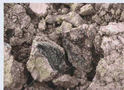
Des mottes et des fragments anguleux sont les indices de sols compactés travaillés en outre dans des conditions humides.
