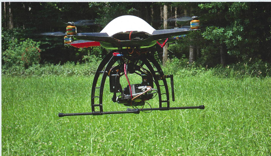
Illustration 3. Le multicoptère est muni d'une caméra thermique installée sur deux axes pour détecter les faons. (Source: Nicole Berger)
