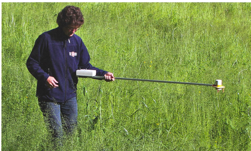
Illustration 6. Le détecteur à infrarouge de la HAFL permet de retrouver les faons dans les hautes herbes, lorsque leur position est à peu près connue. (Source : Walter Berger)
