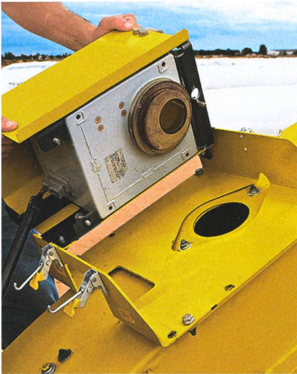
Le dispositif d'analyse monté sur le bec éjecteur de l'ensileuse délivre en continu les valeurs concernant la composition et le taux de MS de la récolte. (Photo d'usine)
