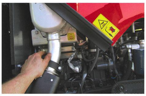
Le capot abrite un moteur Kubota 4-cylindres à 4 soupapes et injection centrale à rampe commune.
