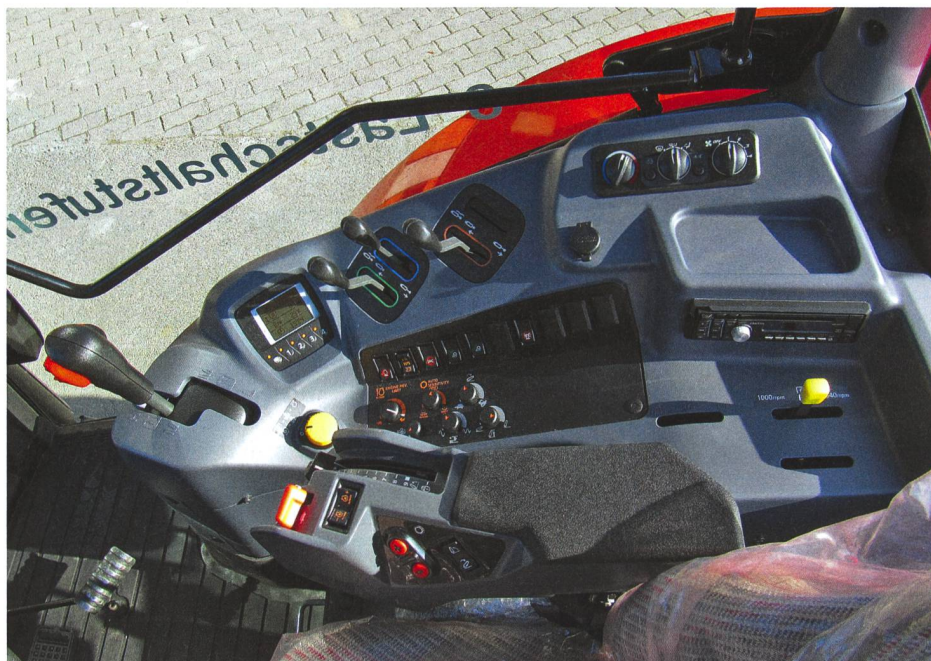
L'écran et les commandes sont sur le côté droit de la cabine. L'ergonomie de cette disposition est bien pensée.
