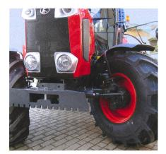
La transmission avant à engrenages coniques permet d'optimiser l'angle de braquage.
