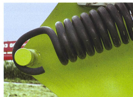
Les unités de coupe sont suspendues et se conduisent en douceur sur le sol grâce à des ressorts réglables.
