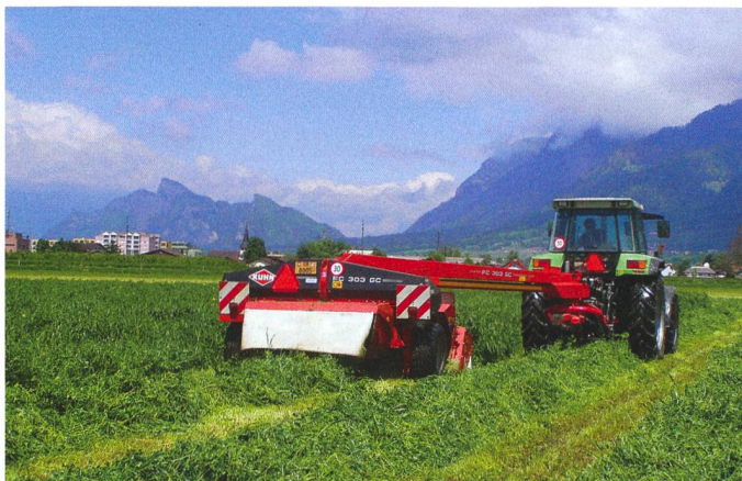
En revanche, la fixation centrale permet de travailler à gauche ou à droite du tracteur. (Photo: Ruedi Hunger)
