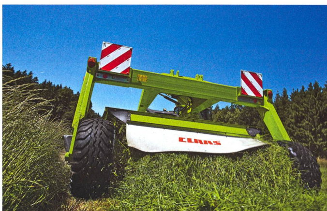
La largeur des andains se règle grâce à un déflecteur. (Photo: Ruedi Hunger)
