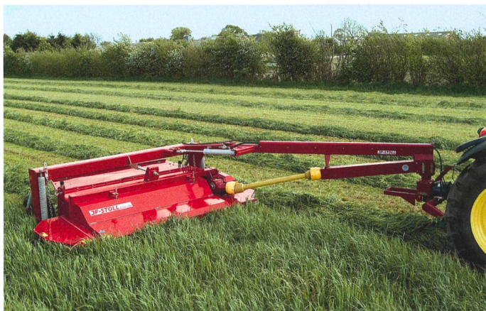
La fixation du timon latérale « condamne » le conducteur à tourner en rond. (Photo d'usine)
