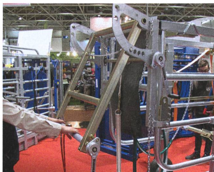
Sand Texas Trading avec treuil arrière réglable en hauteur et relevable.
