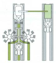
Fig. 9: Filière de récoltes des prairies permanentes avec hacheuse (largeur extérieure 3,30 m). Avec une largeur de fauche de 9 m, la surface de circulation représente environ 25 % en raison des voies de passage plus larges.
