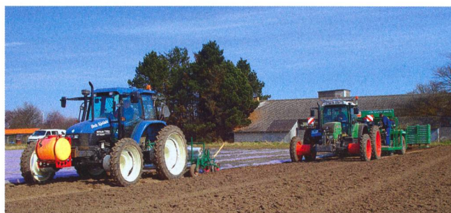
Fig. 1, en haut: Field Power Unit (FPU) avec une largeur de travail de 5,80 m et des roues orientables à 90°. Sur la parcelle, la machine progresse dans le sens de la largeur et sur la route dans le sens de la longueur. En dessous: tracteurs avec des voies de passage plus larges dans des cultures maraîchères en Hollande. Source: Chamen, Pedersen
