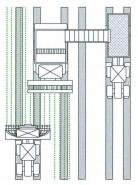
Fig. 11: Schéma d'un système de mise en place des betteraves à neuf rangs d'une largeur de travail de 4,50 m. Le pourcentage de la surface de circulation est d'environ 27%. La distance de transbordement mesure 5,40 m.
