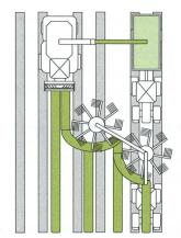
Fig. 7: Prairie temporaire/Production fourragère avec hacheuse. Le fourrage est déposé dans la voie de passage de la hacheuse à l'aide d'une andaineuse latérale.
