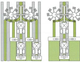
Fig. 6: Prairie temporaire basée sur l'utilisation du tracteur, à gauche avec une largeur de travail de base de 4,50 m, le pourcentage de la surface de circulation est d'environ 27 %. A droite avec 9 m, ce pourcentage baisse à 13 %.
