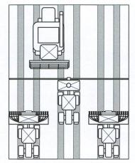
GB: Le système de tracés CTF TwinTrac avec des voies de circulation de 1,80 et 2,7 mètres aboutit à une largeur de travail principale de 4,5 mètres. La moissonneuse batteuse est en décalage d'une demi-voie par rapport au tracteur. La circulation affecte environ un tiers de la surface.
