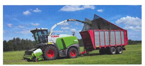
DK: Le ramassage n'est plus effectué par un véhicule circulant de front avec une largeur de travail de 12 m dans le système CTF danois. L'ensileuse tracte elle-même une remorque. Les voies de passage occupent environ 13 % de la surface avec des pneus de 800 mm de large.
