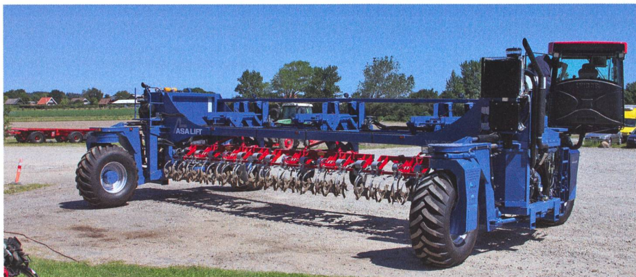
NL: Un porte-outils avec trois outils standard de 3 mètres de large attelés aux 3-points de la machine. (Source : Hans Henrik Pedersen)
