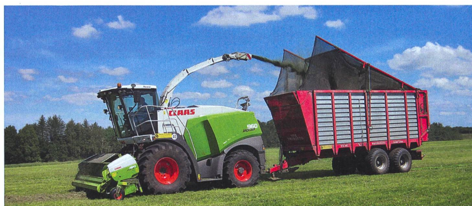
DK: Le ramassage n'est plus effectué par un véhicule circulant de front avec une largeur de travail de 12 m dans le système CTF danois. L'ensileuse tracte elle-même une remorque. Les voies de passage occupent environ 13 % de la surface avec des pneus de 800 mm de large.
