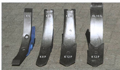
Pour le travail en profondeur, Lemken propose quatre types de socs.
