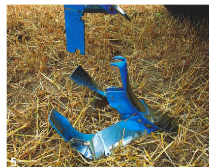
4 Le système d'Evers prévoit le maintien du soc avec deux chevilles.
