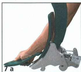
7 Le verrouillage de soc de Vogel & Noot se fait par un arceau sur ressort.
