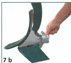
7 Le verrouillage de soc de Vogel & Noot se fait par un arceau sur ressort.
