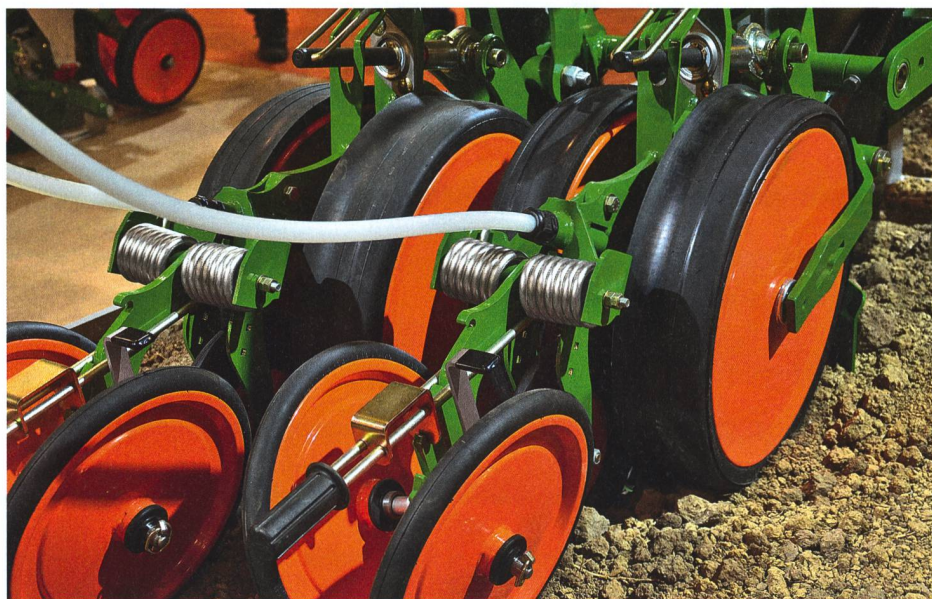
Les graines sont éjectées sous pression par ce tuyau. Une roue en gomme les prend en charge à la sortie.
