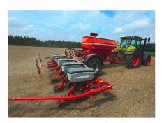
Ce semoir transporte des stocks suffisants pour ensemencer de vastes surfaces grâce à sa citerne combinée à sa trémie.
