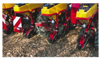
Disposé directement devant ou entre les roues d'appui, le rouleau presseur appuie la graine et la met en contact étroit avec la terre.
