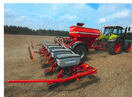
Ce semoir transporte des stocks suffisants pour ensemer de vastes surfaces grâce à sa citerne combinée à sa trémie.
