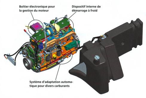
L'électronique prend, en quelque sorte, le relais du deuxième réservoir sur le Multi-Fuel-Tractor.
