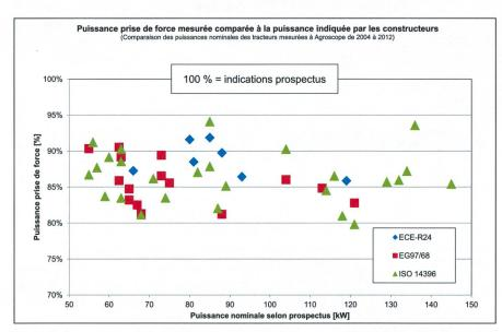
Figure 2: Comparaison entre la puissance à la prise de force mesurée au banc d'essai et celle indiquée par le constructeur (=100 %). Avec la mesure à la prise de force, l'entraînement, les pompes hydrauliques et autres agrégats absorbent de la puissance.
