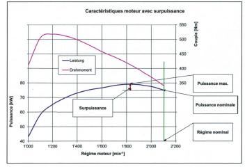
Figure 3: Courbes de puissances nominale et maximale avec surpuissance résiduelle.
