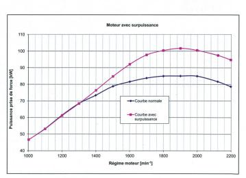
Figure 4: Courbes de puissance avec et sans surpuissance.
