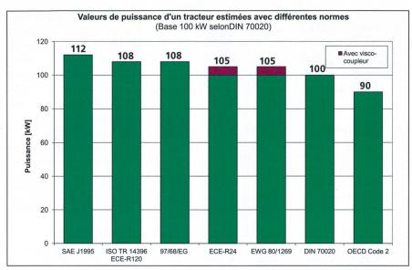
Figure 1: Illustration des normes les plus fréquentes. Les valeurs de puissance en relation avec la norme de mesure pour un tracteur de la classe 100 kW restent approximatives. Des différences sont possibles selon les types de moteur et de tracteur.
