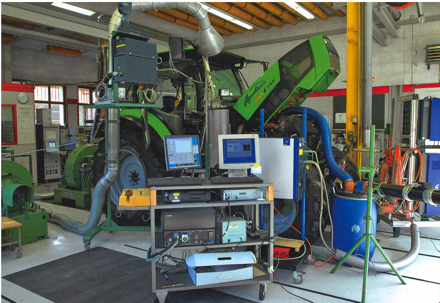
Mesure de la puissance à la prise de force selon la norme OCDE dans le laboratoire d'Agroscope.
