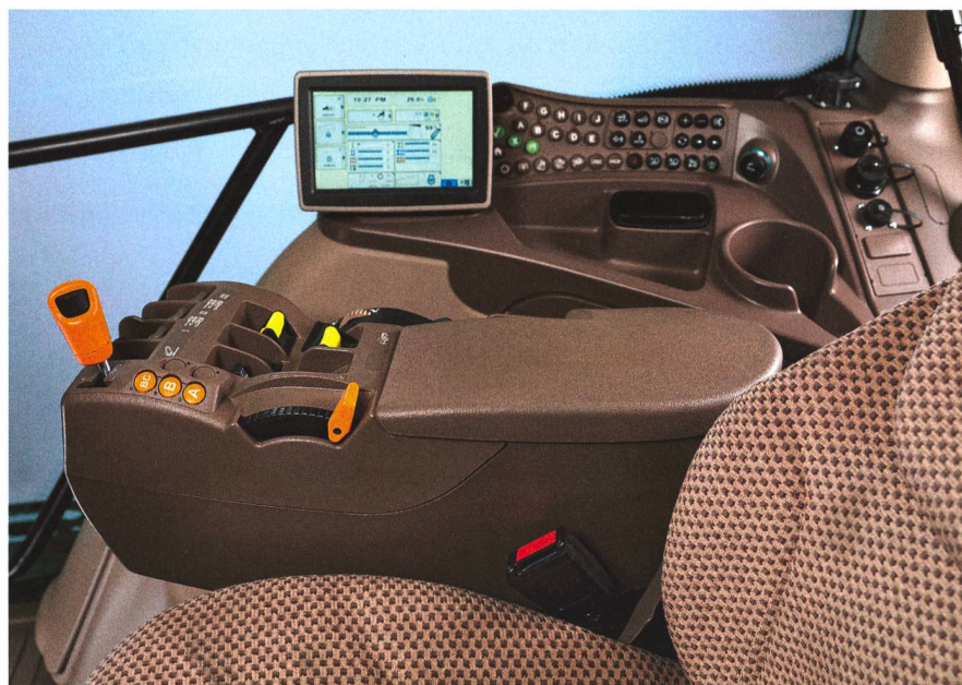
Le levier de la DirectDrive est placé dans la console de l'accoudoir. Il est très facile à manipuler avec le mode automatique à droite et la commande manuelle de la transmission dans la coulisse de gauche.
