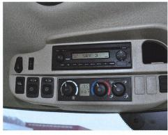
Les commandes de la climatisation, du chauffage et de la radio sont facilement accessibles.
