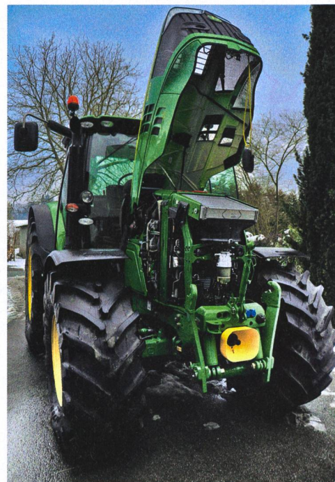
L'angle d'ouverture généreux du capot moteur, tout d'une pièce, offre un accès aisé aux points d'entretien névralgiques.
