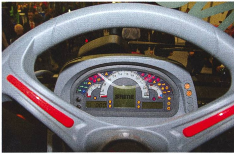
Le conducteur garde la vue d'ensemble des fonctions en cours et des outils connectés grâce à un affichage fonctionnel.
