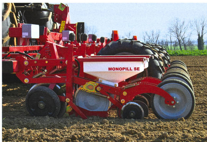
Les éléments d'équipement sont conçus de manière à assurer la profondeur de semis la plus régulière possible. Les mouvements parasites à proximité de l'endroit de dépôt doivent être absorbés. (Photo d'usine)
