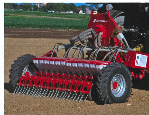
Des semoirs monograine avec un faible écartement des lignes sont recommandés pour la culture maraîchère. (Photo d'atelier)
