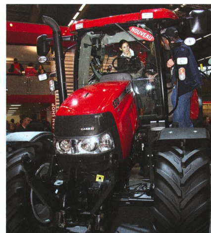
La cabine panoramique est dotée d'une très bonne insonorisation, seuls 71 db(A) parviennent aux oreilles du pilote.
