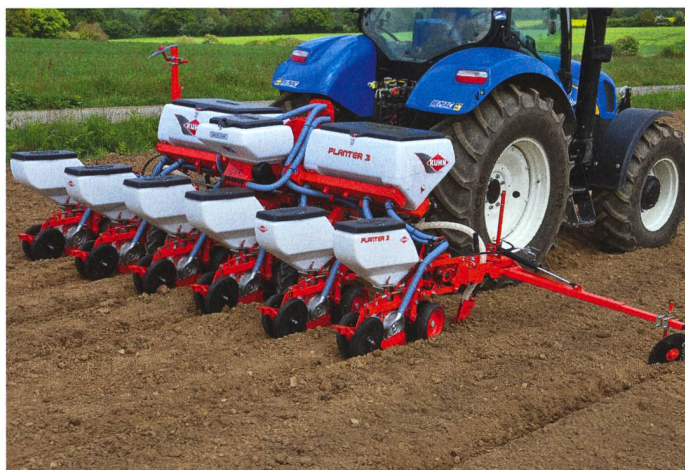
Machine monograine à six rangs avec châssis télescopique, épandeur et socs à engrais ainsi que distributeur de microgranulés. (Photo d'usine)
