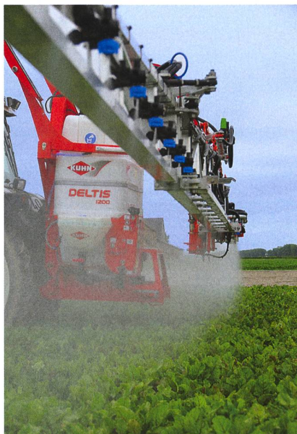
L'enclenchement et le déclenchement des sections se font par les soupapes pneumatiques par impulsion, positionnées sur les buses du Kuhn Deltis 1200. (Photo: Kuhn)
