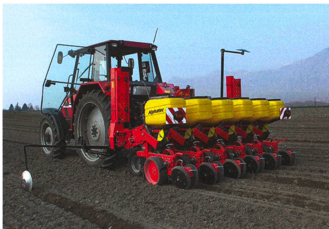
Des performances plus élevées ne sont atteignables que par une vitesse ou/et une largeur accrues également dans la technique monograine. (Photo d'usine)
