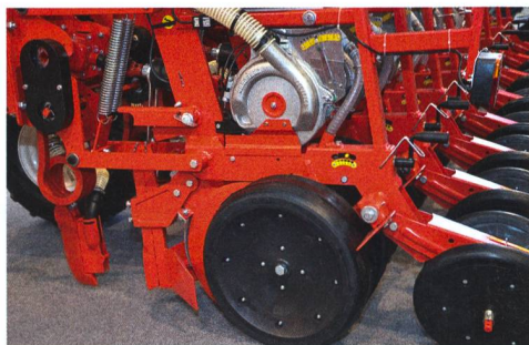
La compatibilité au semis sous litière implique que le distributeur de semences se trouve plus haut. Cela entraîne une hauteur de chute des graines plus importante. (Photo : Ruedi Hunger)
