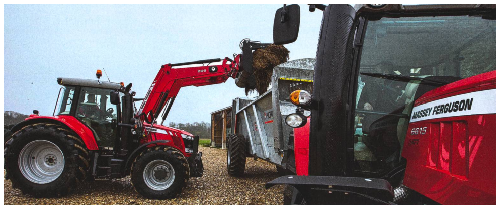
Les tracteurs Massey Ferguson 6600 sont à la fois compacts et maniables grâce à leur moteur à 4-cylindres.
