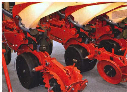
Le réglage des roulettes de guidage de profondeur et des roues plombeuses nécessite une manipulation aisée. (Photo : Ruedi Hunger)
