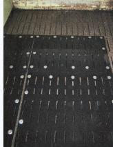
Tapis en caoutchouc avec un pourcentage de perforations de 10 % (Fabricant: Kraiburg Elastik GmbH en Allemagne)
