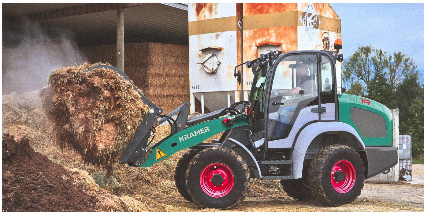
La direction sur quatre roues du nouveau chargeur de Kramer offre une stabilité améliorée par rapport aux véhicules avec articulations de direction. (Photos SPAA/ R. Burgherr)
