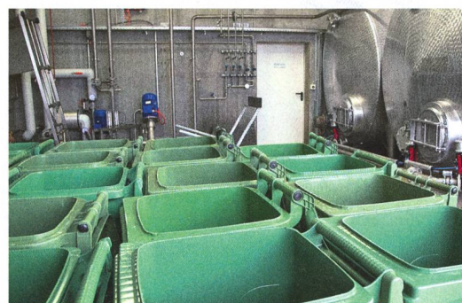
Dans ce local, les « lavures » de restauration sont stérilisées (étuves à d.) et les contenants lavés après chaque utilisation. Agri Bio Val traite 500 tonnes de déchets alimentaires par an.
