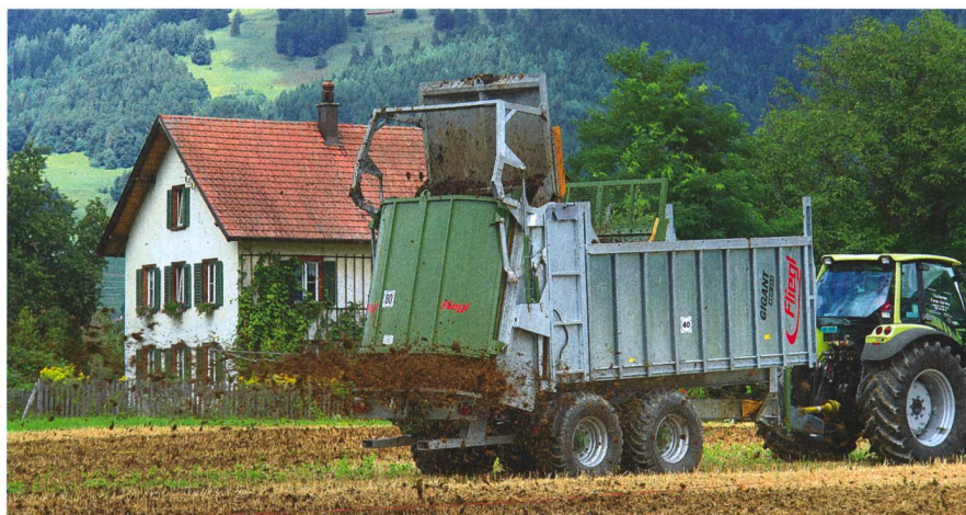
Les épandeurs à fumier avec rouleaux séparés et assiettes de répartition peuvent compenser de légères irrégularités de chargement grâce à leur mode de travail.
