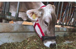
Capteur de pression RumiWatch fixé au museau de l'animal par une bride nasale. La sonde contient un liquide qui réagit aux mouvements de la mâchoire. Les composantes électroniques du système sont placées des deux côtés dans des boîtes de plastique étanches.
