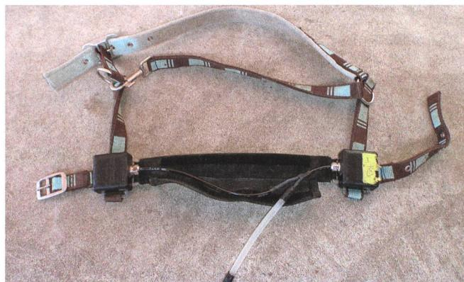
**Capteur de pression RumiWatch fixé au museau de l'animal par une bride nasale. La sonde contient un liquide qui réagit aux mouvements de la mâchoire. Les composantes électroniques du système sont placées des deux côtés dans des boîtes de plastique étanches.**
