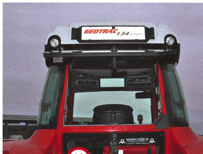
La sélection d'une vitesse de marche arrière déclenche le fonctionnement de la caméra de recul et la transmission de l'image vers le rétroviseur intérieur, où apparaît aussi l'affichage de la navigation.
