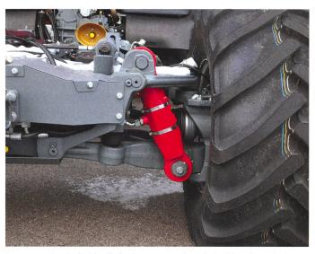
La suspension individuelle hydropneumatique à double triangulation offre une course de 100 mm et peut être bloquée.
