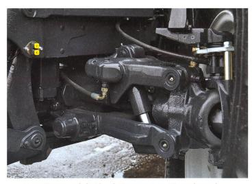
L'amortissement de l'essieu de Carraro est monté, sur demande, pendant la fabrication.
