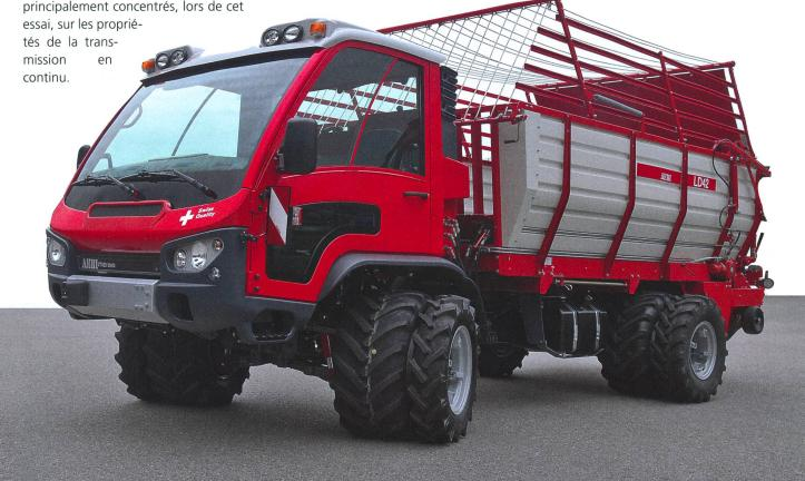
puissance. Les travaux qui nécessitent des vitesses lentes sont possibles sans investissement supplémentaire pour une boîte rampante. Le transporteur est exploitable de manière efficace et rentable au moyen de l'ECO-Drive et d'une efficacité de transmission élevée. Ces avantages s'avèrent d'autant plus intéressants que le surcoût du VT450 par rapport à la transmission manuelle, selon Aebi, ne s'élève qu'à un peu plus de CHF 3000.–!
