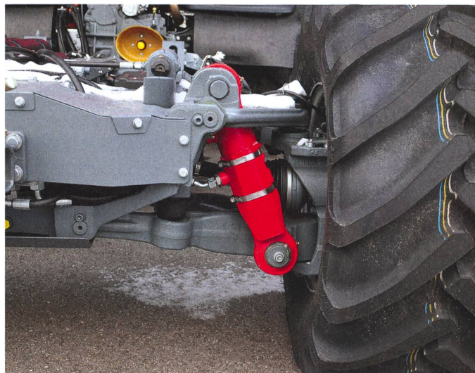
La suspension individuelle hydropneumatique à double triangulation offre une course de 100 mm et peut être bloquée.
