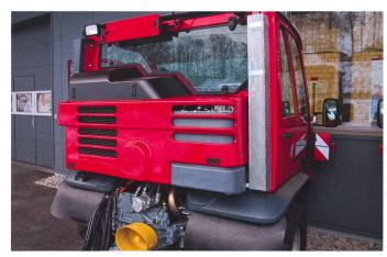
Les pompes hydrauliques sont placées directement sur la transmission de même que le radiateur à huile. Les conduites hydrauliques sont ainsi très courtes.
