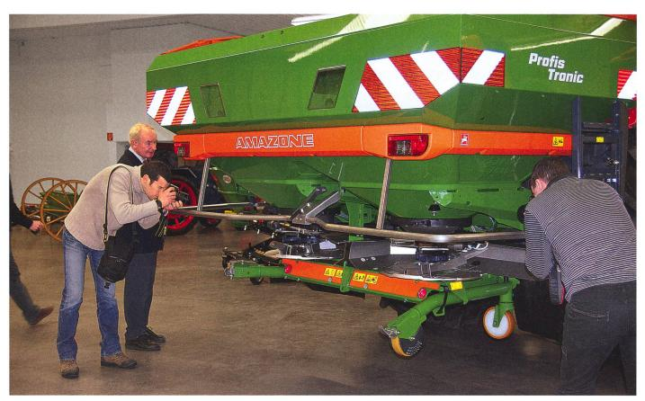
Les objectifs sont braqués sur le dispositif d'épandage du ZA-TS Profi. Le cadre de protection et le dispositif de dépose amovible à roulettes attirent l'attention. (Photo: Ueli Zweifel)
