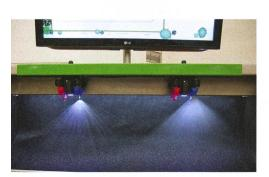
Des jets variés avec l'AmaSelect pro: plusieurs types de buses fonctionnent simultanément sur une même rampe, à pression constante, en diffusant des jets aux caractéristiques différentes.
