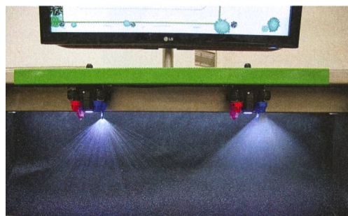
Des jets variés avec l'AmaSelect pro: plusieurs types de buses fonctionnent simultanément sur une même rampe, à pression constante, en diffusant des jets aux caractéristiques différentes.
