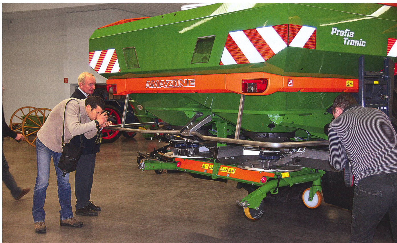
Les objectifs sont braqués sur le dispositif d'épandage du ZA-TS Profis. Le cadre de protection et le dispositif de dépose amovible à roulettes attirent l'attention. (Photo : Ueli Zweifel)
