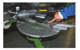
Tout nouveau: des moteurs électriques règlent le débit et l'orientation des aubes en position «normale» ou «bord de champ». On distingue aussi l'entraînement électrique de la tige d'agitation.
