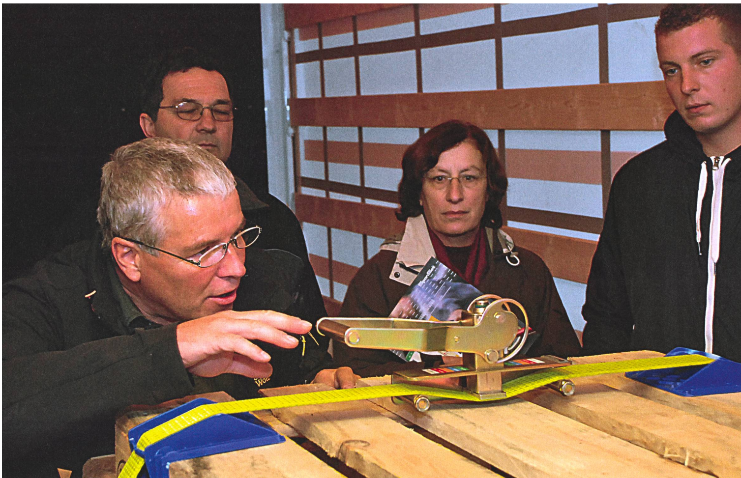
L'instructeur Fritz Mühlemann en train de mesurer la force de précontrainte d'un élément de tension; les glissières sur les bords assurent une répartition régulière de la force agissant sur les deux côtés du chargement. (Photos: Dominik Senn)
